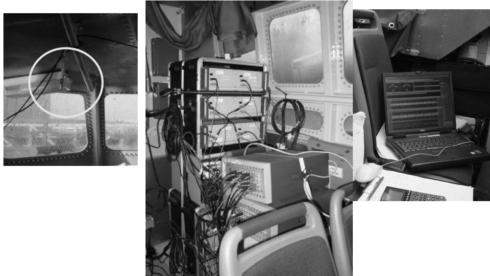
Abbildung 48: Links: Mikrophon im Fahrgastraum; Mitte: Verstärker- und Messtechnik; Rechts: Messrechner
