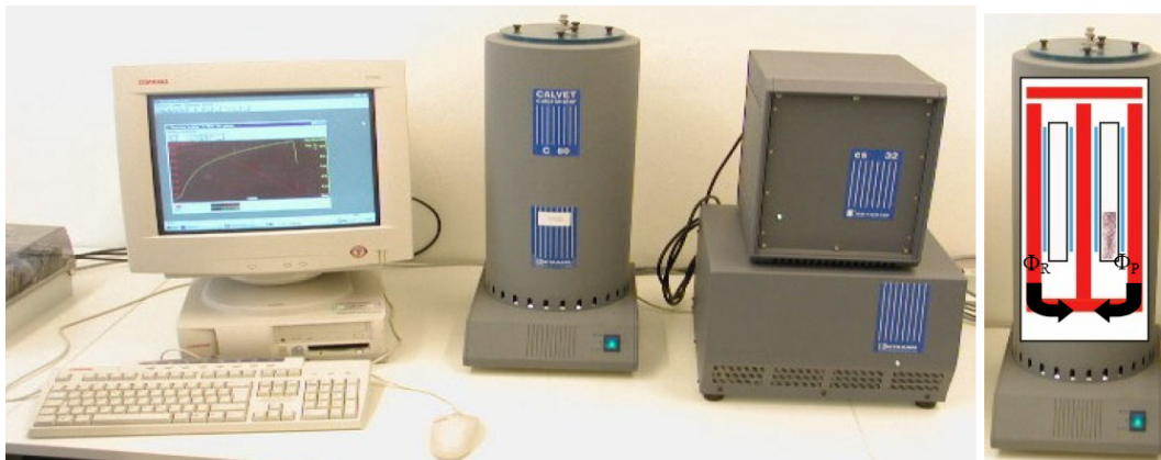
Abbildung 2.7: Messanordnung und Messprinzip des Wärmestromdifferenz-Kalorimeters. Die Messapparatur besteht aus vier Komponenten: Rechner, Kalorimeter sowie dem Controller auf dem Netzteil (von links nach rechts).
