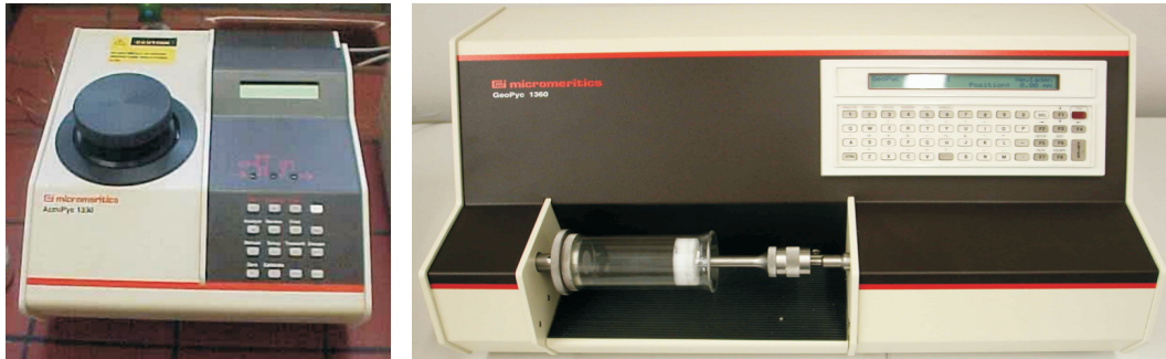
Abbildung 2.5: Anordnung der Dichte- und Porositätsmessung. Links: Helium-Pyknometer zur Bestimmung der Reindichte der Probe. Rechts: Feststoff-Pyknometer zur Bestimmung der Rohdichte der Probe.
