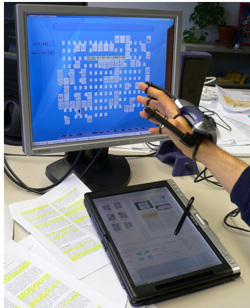
Abb. 16: Aufbau des finalen Demonstrators: 3D-Bildschirm, Datenhandschuh und Tablet-PC.
