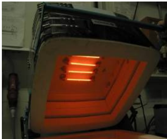
Abb. 4320-05: Schema und Betrieb des DLR Schnellheizofens.
