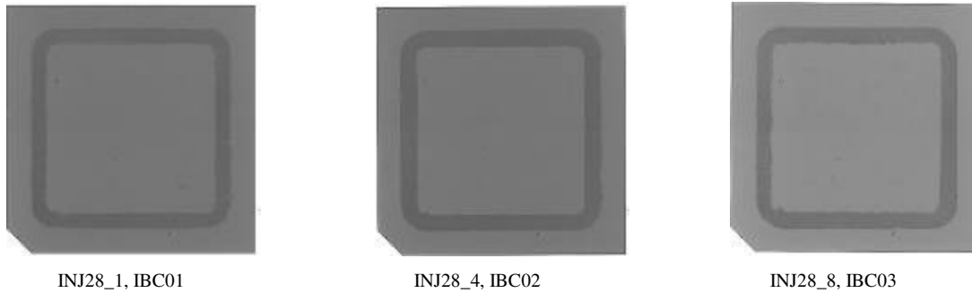
Abb. 4340-2: Röntgenbilder der Lotkontur nach dem Fügen der Varianten Cf/3YSZ/Metallisierung//IBN03/Cf. Verwendete Metallisierungen: IBC01, IBC02 und IBC03, Lötlast 0,8 kg.
