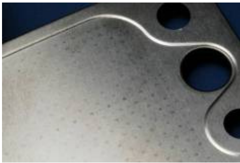
Abb. 4320-19 Rückseite der Unterschale CS-W-213. Die Abdrücke des angeschweißten Ni-Netzes sind deutlich sichtbar. Jede Masche hat angebunden.
