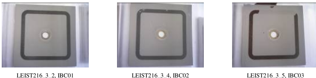
Abb. 4340-4: Bilder der Metallisierung auf 3YSZ-Blech nach dem Ofenlauf. Verwendete Metallisierungen: IBC01, IBC02 und IBC03.
