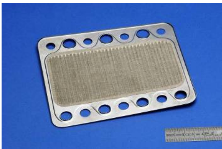
Abb. 4320-18: Unterschale mit Wellenstruktur, die mit einem feinen Ni-Netz verschweißt wurde (CS-W-73). Das Bauteil ist über die Diagonale verzogen.
