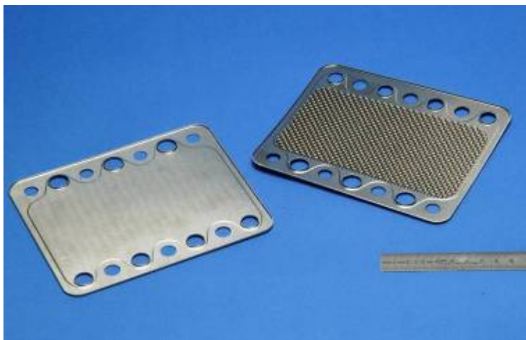
Abb. 4320-17: Vergleich einer ebenen Unterschale ohne Wellenstruktur (CS-W-249) mit einer Unterschale, die mit einem groben Ni-Netz verschweißt wurde (CS-W-213). Nach dem KE-Schweißen ist das Bauteil über die Diagonale verzogen.
