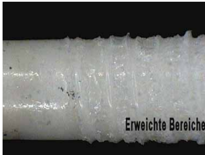
Abb. 17: Kalium-Glasschicht nach der Aufheizung im Detektor
