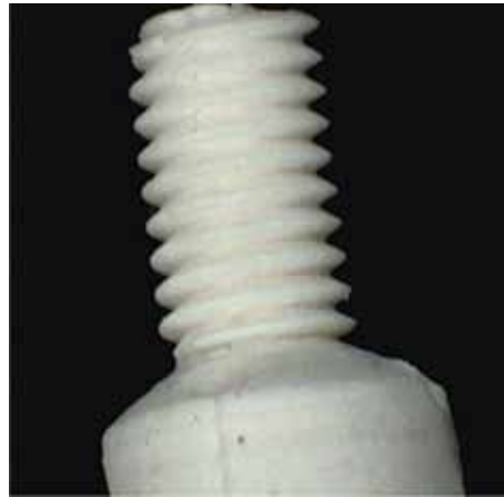
Abb. 37: Schraubenförmiger Keramikkörper für den Anoden-Heizer
