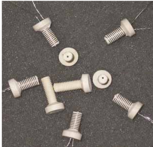
Abb. 47. Schraubenförmiger Keramikkörper für den Anoden-Heizer
