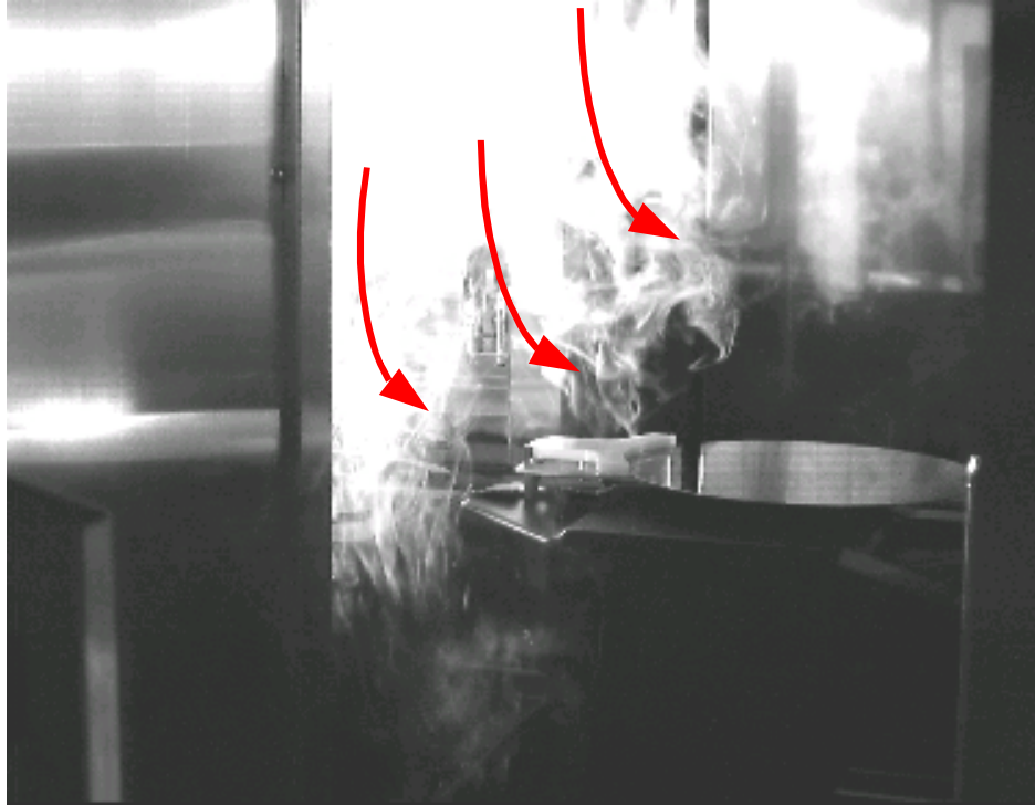
Bild 14: Strömungsverhältnisse bei einer FFU Drehzahl von 1000 U/min
