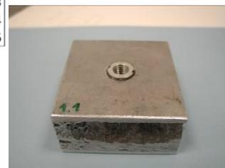
Abb. 32: Auszugs-Prüfung der Nietmutter geklebt, Nietmutter um etwa 1 mm herausgezogen
