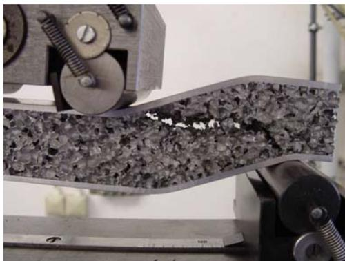
**Abb. 11: 4PB Versuch, 34 mm Sandwichdicke**
