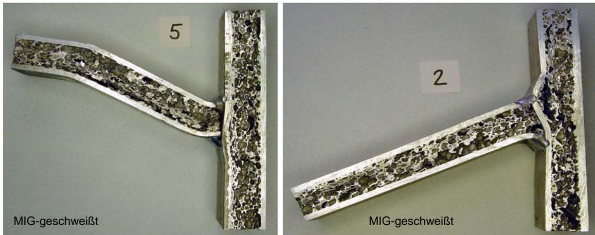
**Abb. 45: (links) Versagen durch Schubbelastung, (rechts) Versagen durch Abheben der Deckplatte im Gurt**
