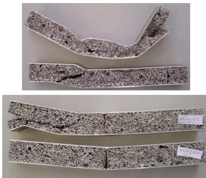
Abb. 39: Versagen an ungeschweißten und geschweißten Sandwich-Verbunden
