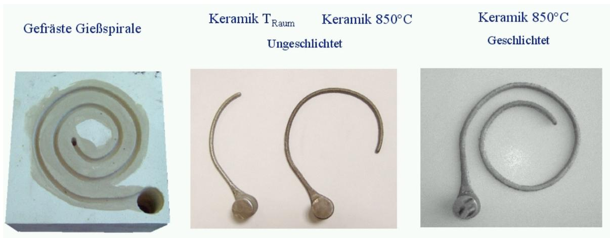
Bild 15: Versuchsergebnisse für den Stahl GX40CrNiSi25-20
