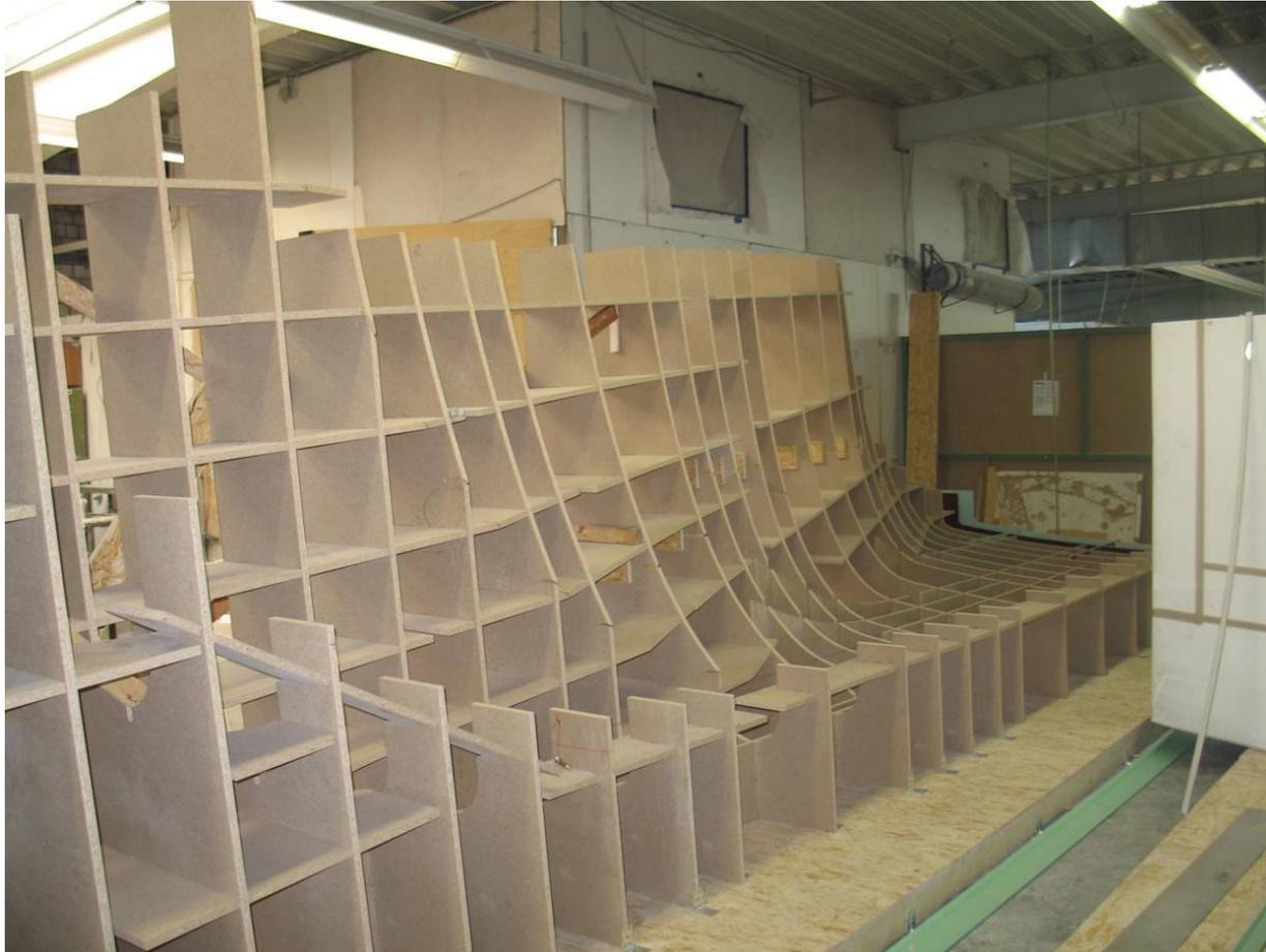
**Bild 3.2.8** Beispiel einer Laminierform in Skelettbauweise
