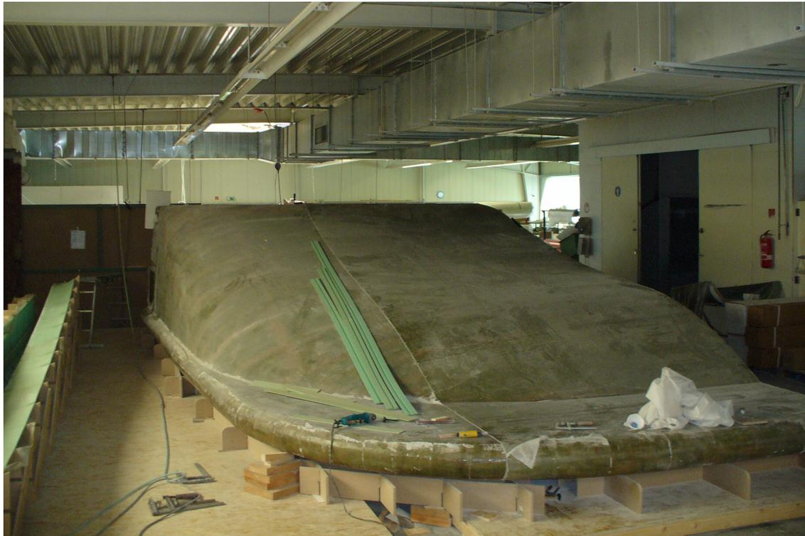
**Bild 3.5.12 Bauteile einer Decksverkleidung mit Sandwichlaminaten**
