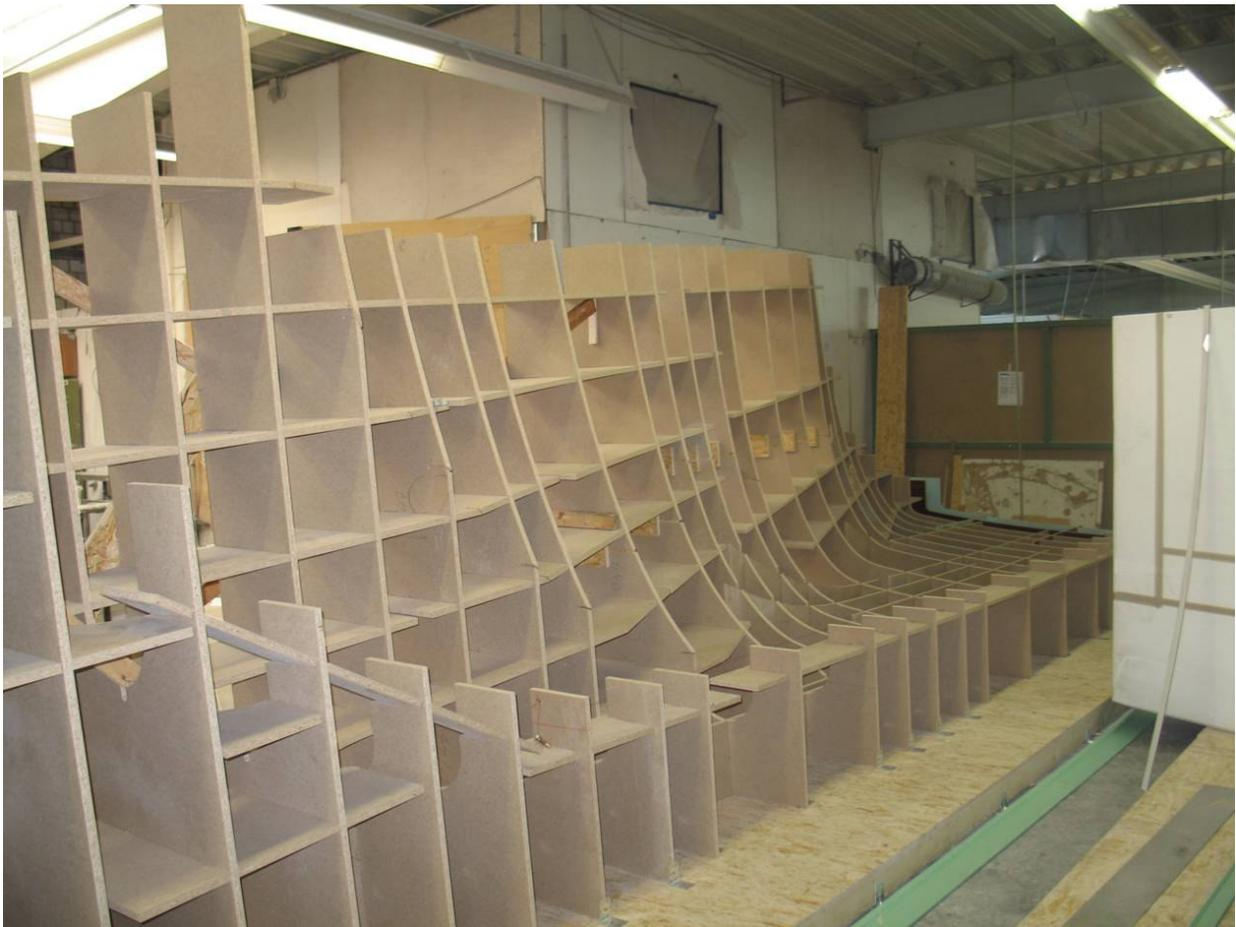
**Bild 3.5.10 Skelettmodell zum Formenbau für Teile einer Decksrüstung**
