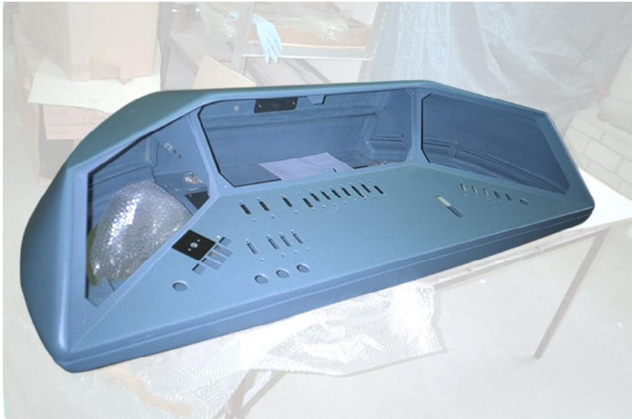
**Bild 3.5.8 Laminiermodelle für Fahrpulte**
