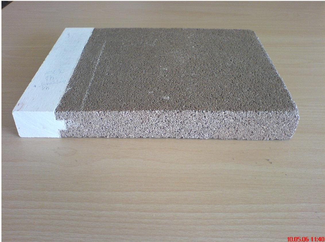
**Bild 3.4.2** Thermisch hochbelastbares Plattenmaterial (T bis 1.100 °C)
