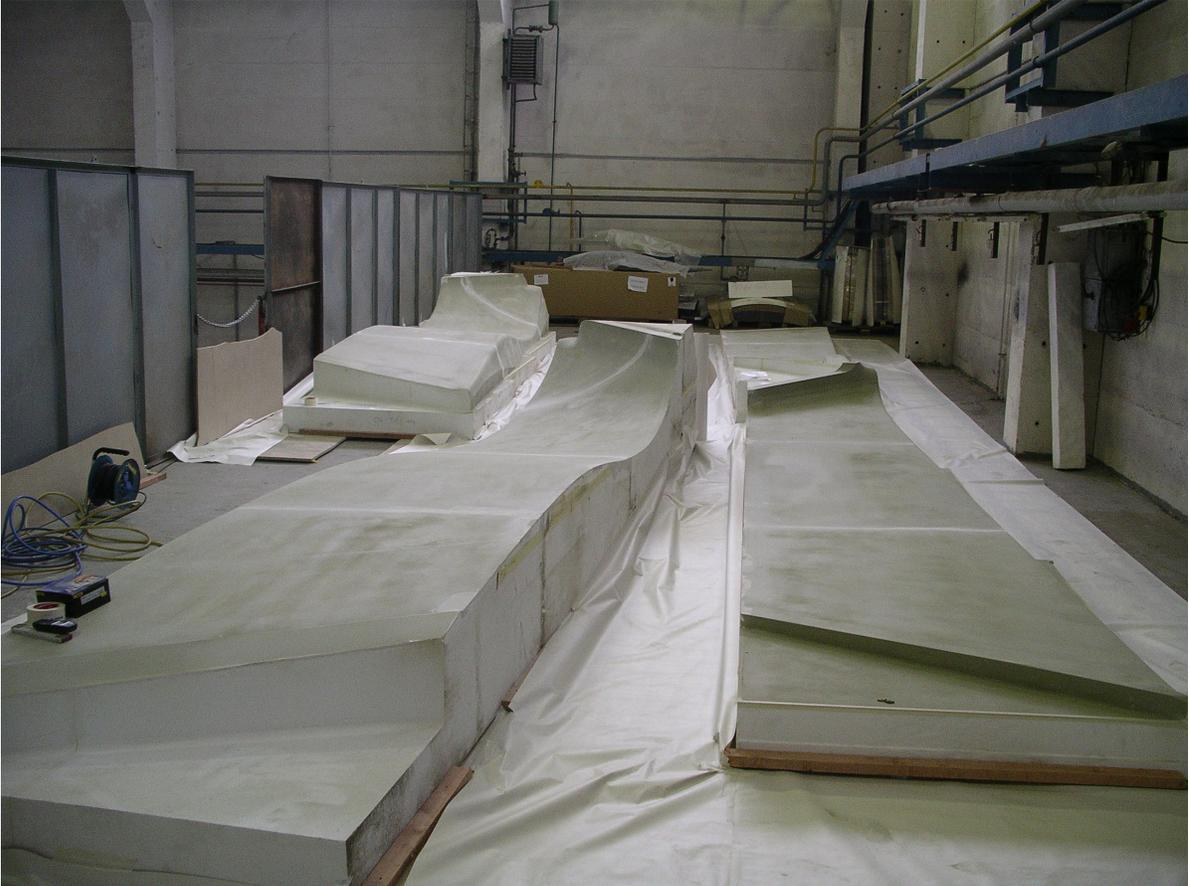
**Bild 3.5.7**    **Gefräste Laminierform für Flügelemente eines Bodeneffektfahrzeuges**
