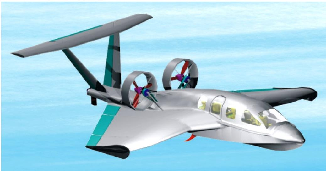
**Bild 3.5.5** Oberflächenmodellierung der vollständigen Oberfläche eines Bodeneffektfahrzeuges
