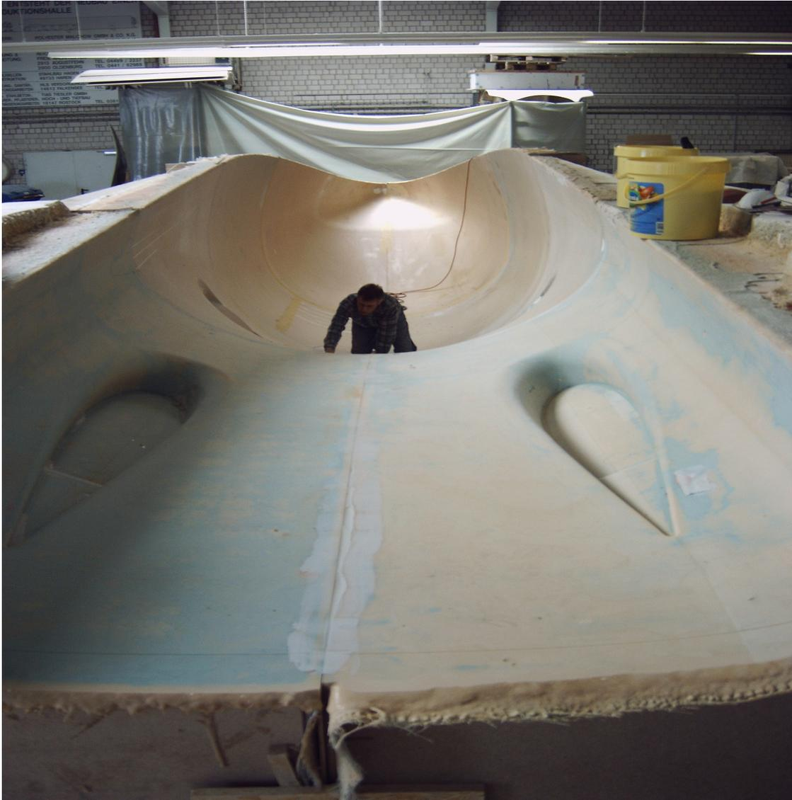
**Bild 3.5.9** Hybrides Laminiermodell für die Oberschale eines Bodeneffektfahrzeuges ( $L = 15\text{ m}$ )
