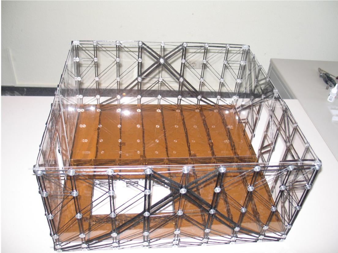
**Bild 3.6.1 Modell der Raumzellen-Module 410/412 des 2. Decks im Deckshaus**
