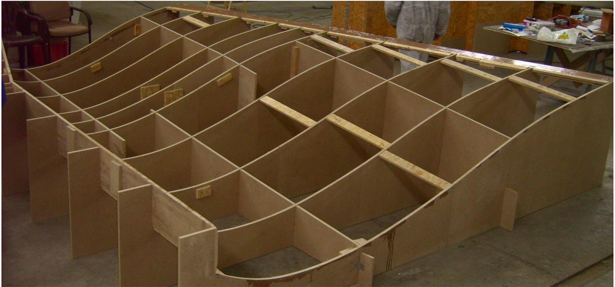
**Bild 3.5.11** Skelettmodell zum Formenbau für die Flügeloberschale eines Bodeneffektfahrzeuges
