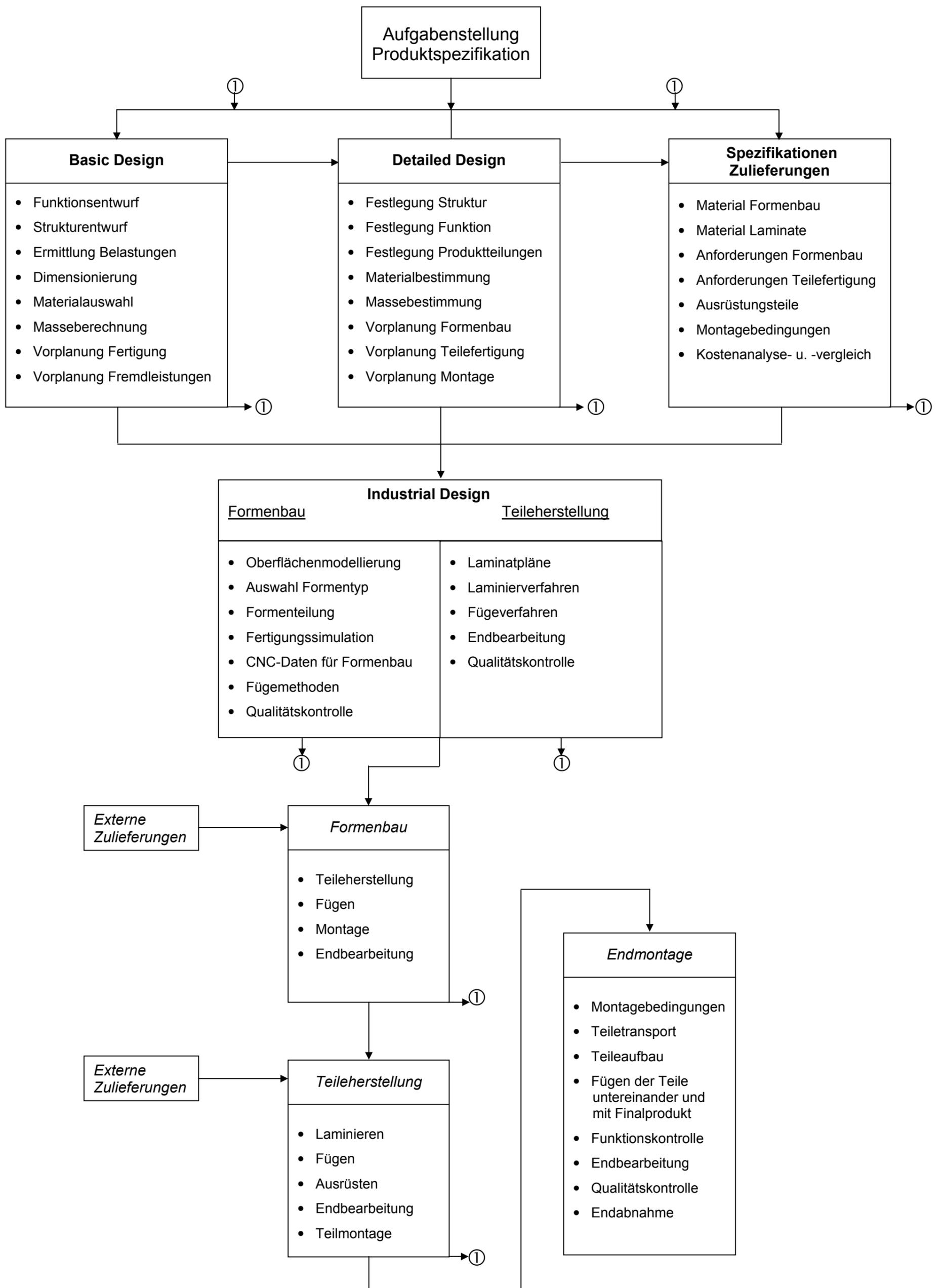
**Bild 3.3.1 Iterativer Entwicklungs- und Fertigungsprozess für modulare Leichtbaustrukturen**
