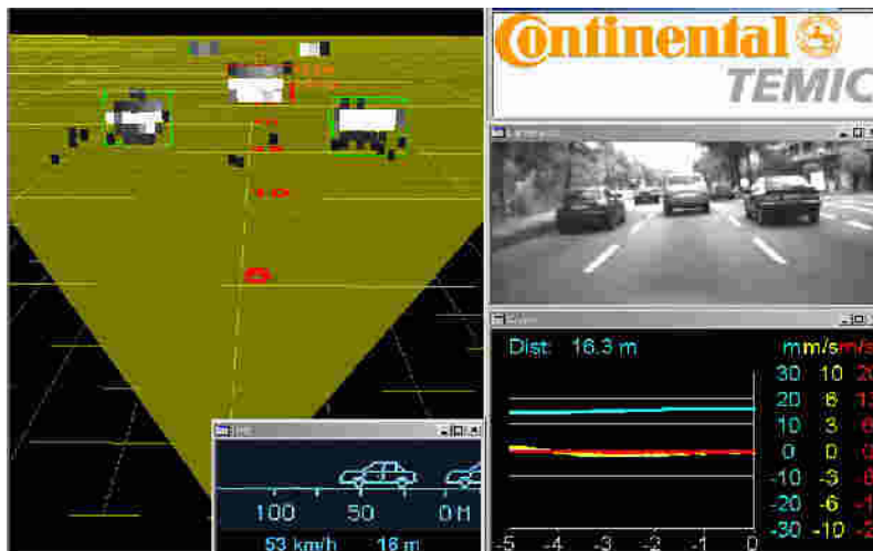
Abbildung 50: typische S&G-Folgesituation: Das System erfasst alle wichtigen Objekte mit guter Auflösung.
