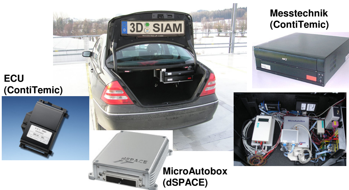
Abbildung 39: Rechnerplattformen im Kofferraum zur Fahrzeugsteuerung
