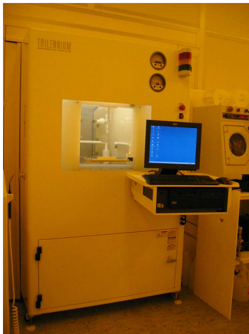
Bild 2.3: Links: Im FBH-Reinraum installierter SSEC-Ätzprozessor Rechts: Prozesskammer des Ätzprozessors (Bild oben) und Verlauf des Ausgangssignals des Endpunkterkennungssystems bei zwei hintereinander geätzten InGaAs-Schichten (Kurven liegen direkt übereinander)
