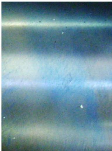
**Abbildung 4-7 In der Oberflächenstruktur einer mechanisch gereinigten Extrusionsschnecke eingelagerte Überreste eines blauen Farbpigmentes [Gr04b]**
