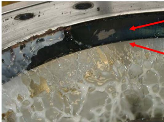
Die Ablagerungen befinden sich nur in den Lagen, wo Funktionspolymere wie z.B. Haftvermittler, Ionomere oder EVA Copolymere mit einem hohen VA Anteil gefahren werden.
