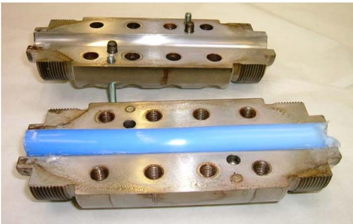
Abbildung 4-2 Geöffneter 2-Schalen-Zylinder mit erkaltetem Extrudat
