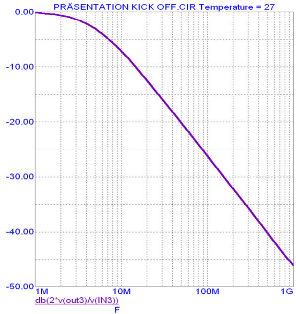
Bild 4.49: Theoretischer Frequenzgang der Einfügungsdämpfung eines C-Filters mit einem idealen Kondensator
