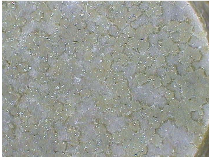
Bild 4.17: Oberfläche einer gesinterten Keramik, hergestellt aus WS-Granulaten unterschiedlicher Komponenten
