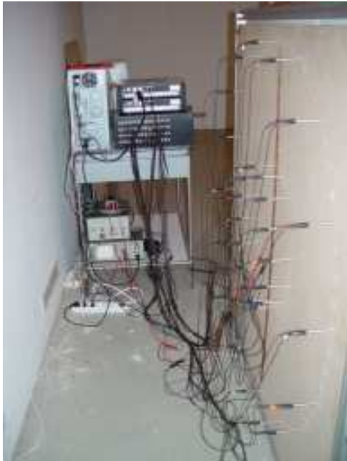
Abbildung 3: Einsatz des Mikrofon-Arrays für die Messungen am AKUSIM-Modell „Strebe“
