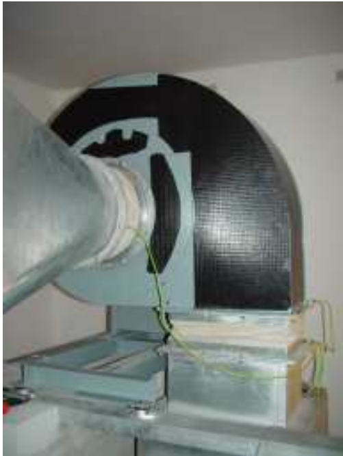
Abbildung 1: Antrieb des Windkanals mit zusätzlich aufgebrachten Dämpfungsbälgen zur Störschallunterdrückung
