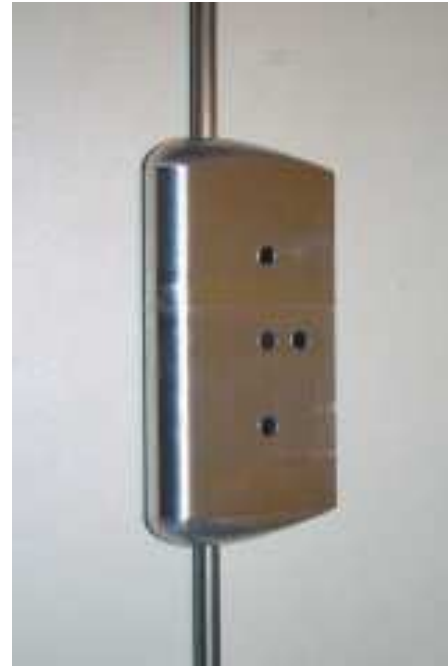
Abbildung 4: AKUSIM-Modell „Strebe“ ( l/d=2.5 ) mit eingebauten Wanddruck-sensoren
