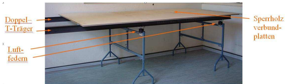
Bild 7: Versuchsaufbau, Modell Schienenfahrzeug
