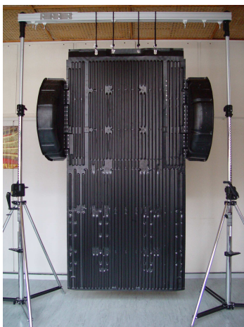
Bild 1: Referenzstruktur: Bodenblech des Volkswagen T4 mit Radhäusern und Detailansicht
