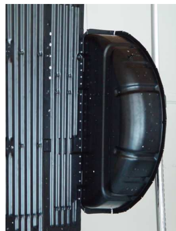
Bild 1: Referenzstruktur: Bodenblech des Volkswagen T4 mit Radhäusern und Detailansicht
