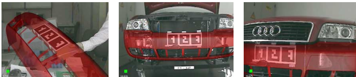
Abbildung 2.3: Stoßfänger Augmentierung am Beispiel des A6-Technikträgers
