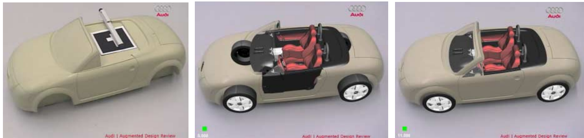
Abbildung 2.6 Exterieur-Fräsmodell mit augmentiertem Interieur (und Reifen) unter Verwendung von Occlusion Objekten
