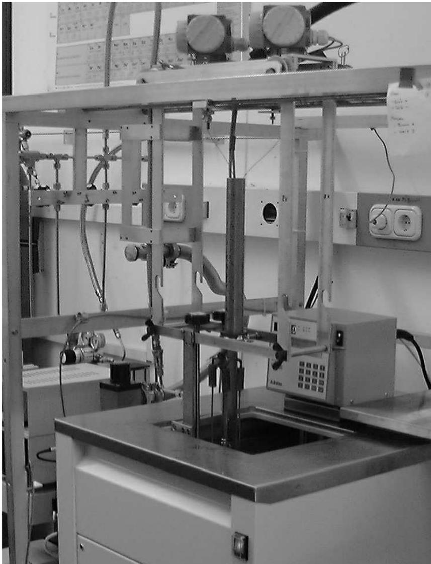
**Abb. 28** : Probenzelle und Thermostat.
