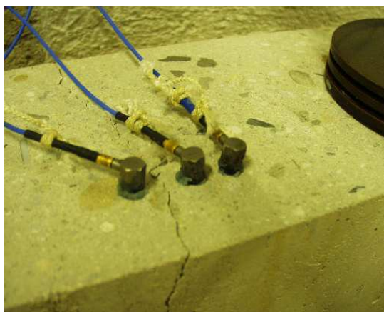
Bild 5.22: Balken mit defektem Beton
