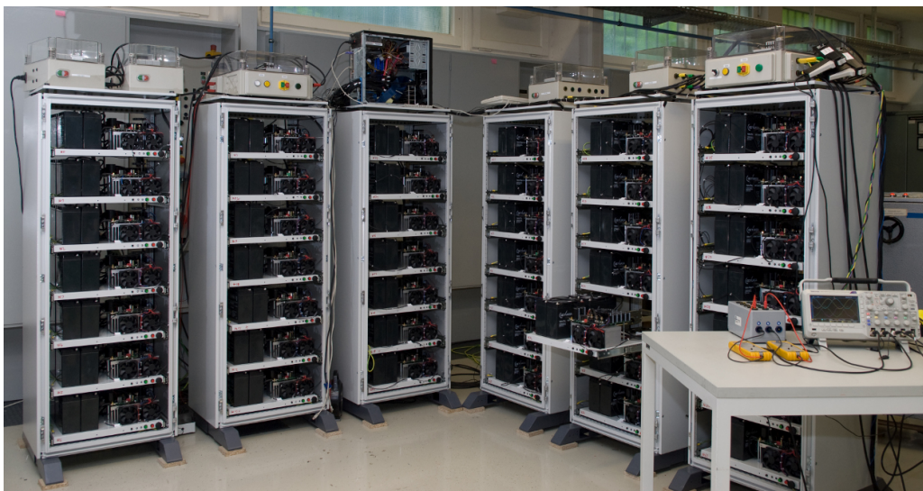
Abbildung 8.1: Aufbau des Hexverters im Labor des IAL
