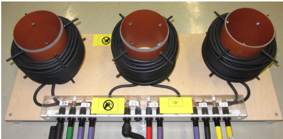
Abbildung 8.6: Aufbau dreier Zweigdrosseln auf einem gemeinsamen Befestigungsbrett
