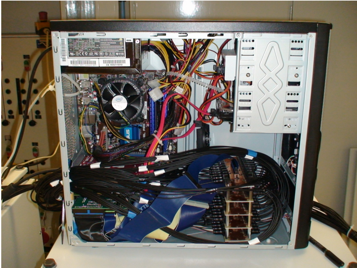
Abbildung 8.9: Laboraufbau des Steuerrechners mit PCI-Karte und Lichtleiterverbindungen
