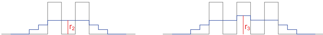
Abbildung 3.15: Linienprofil in \sigma_0 (grau) und in der Zielskala \sigma_z=3 (blau) mit resultierendem Grauwert r_i (rot) für zwei und drei interagierende Objektteile
