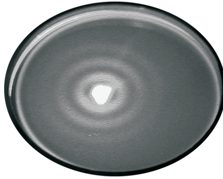
Abbildung 6.12: Auswirkung der Mikrostruktur: Interferenzmuster eines lateral in eine \text{TiO}_2 -Schicht eingekoppelten Laserstrahls der Wellenlänge 532 nm.
