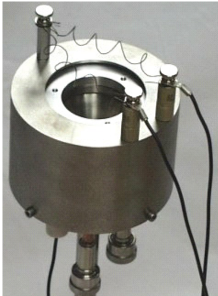
Abbildung 3.4: Ionenquelle Denton CC-105. Zu erkennen sind zwei Neutralisatordrähte (Wolfram), die über der Quellenapertur montiert sind.
