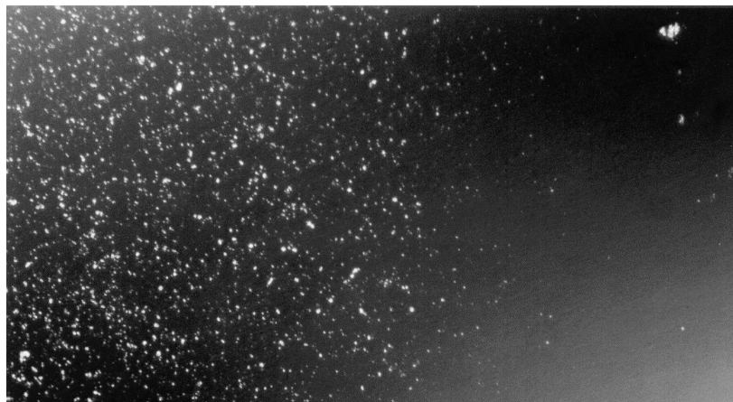
Abbildung 4.5: Probe aus Abbildung 4.4 nach einer Reinigung mit dem Spin-Cleaner.
