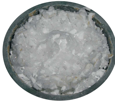
Abbildung 6.19: Oberfläche eines \text{SiO}_2:\text{Al}_2\text{O}_3 -Tiegels nach erfolgter Verdampfung (Verschiebung des Mischungsverhältnisses durch fraktionierte Verdampfung).
