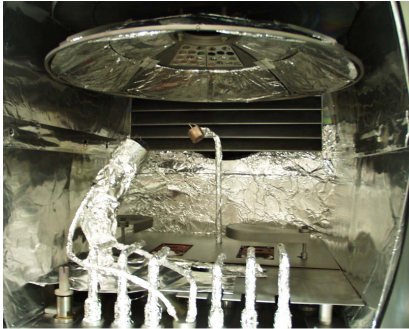
Abbildung 4.1: Blick in den Rezipienten der Balzers BAK 760 Beschichtungsanlage, die in Aluminiumfolie eingekleidete Ionenquelle CC-105 ist in der linken Bildhälfte zu erkennen. Im hinteren Bereich befinden sich zwei Elektronenstrahlverdampfer.
