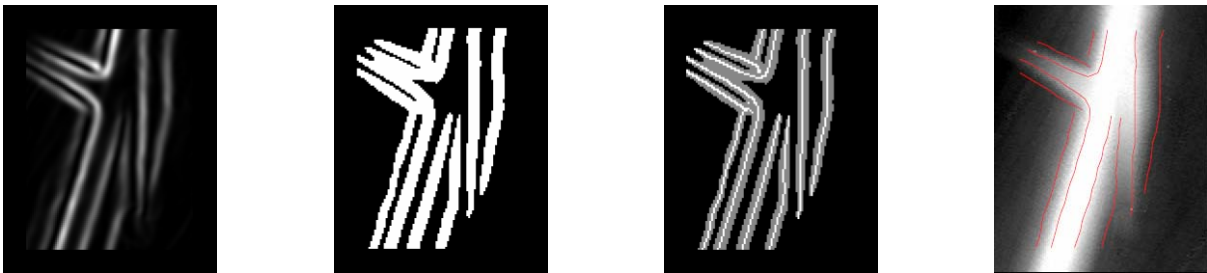
Abbildung 3.4: Ableitung von Bruchkanten an einem Damm mit dem Gauss-Operator in Verbindung mit einem Hypothesentest (Brügelmann, 2000): Testgröße z_2 (links außen), Bruchkantenregionen nach dem Hypothesentest (links), Bruchkantenpunkte nach Non-Maxima-Suppression (rechts), interpolierte Vektorbruchkanten (rechts außen)
