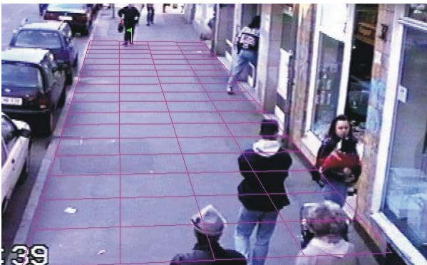
Bild 4.82: 1. Standbild bei der Anwendung von ViVAtraffic zur Gehgeschwindigkeitsmessung
