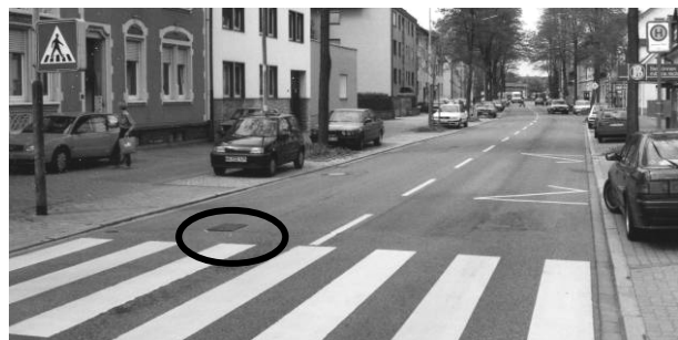
Bild 4.102: Geschwindigkeitsmessungen mit Messplatten in unterschiedlicher Entfernung vom FGÜ in Karlsruhe nach MENNICKEN (1999)
