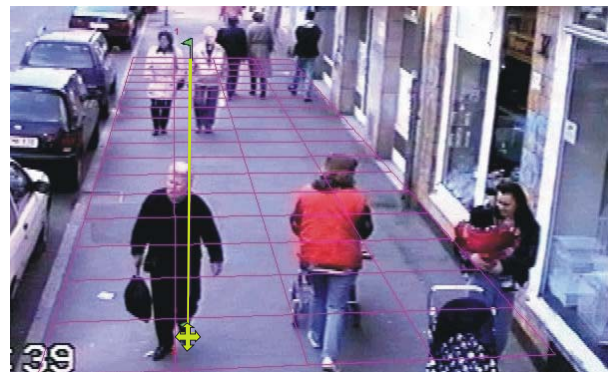
Bild 4.83: 2. Standbild bei der Anwendung von ViVAtraffic zur Gehgeschwindigkeitsmessung
