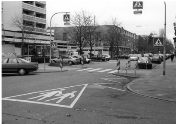
Bild 7.22: Fußgängerüberweg mit baulicher Einengung nach MENNICKEN (1999)
