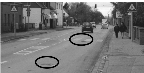
Bild 4.101: Geschwindigkeitsmessungen mit Messplatten in unterschiedlicher Entfernung vom FGÜ in Hannover nach MENNICKEN (1999)
