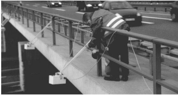
Bild 5.98: Montage der Mehrstrahl-Radarsensoren nach SCHNÜLL, HOFFMANN, KÖLLE, MENNICKEN (2000)
