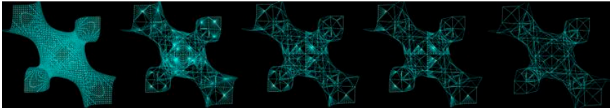
Bild B.6: Das Bild zeigt die Auswirkung des progressiven Abschaltens von Ecken an Cluster- und Prozeß-Grenzen beim Vertex-Clustering. Der rechteste Frame zeigt die Vernetzung, die der Algorithmus bei allen Beispielen genutzt hat.
