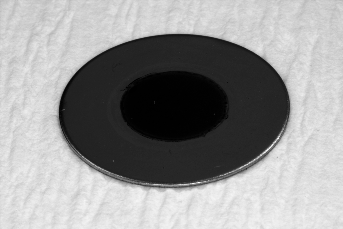
Abb. 39: Durch Elektrodeposition auf Edelstahl (WNr. 1.4301) hergestelltes Messpräparat (Durchmesser der Metallscheibe: 25 mm)
