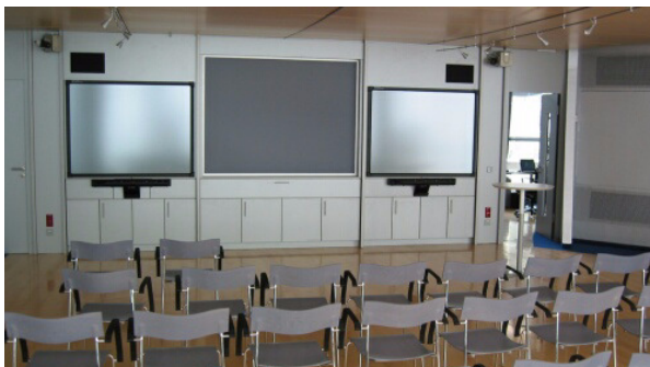
Rückprojektionsflächen: zwei SMARTboards, eine 3D-Stereofähige Projektion (mitte), vier fernsteuerbare Kameras, Beschallung
