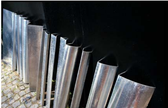
Abbildung 25: Überlaufkörper der Versuchsreihen ÜK (Überlaufkörper)
