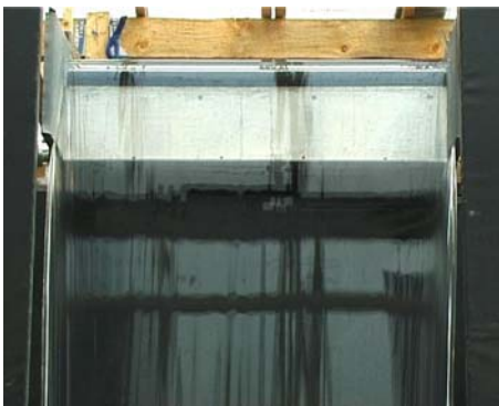
Abbildung 89: Detail - Wasserschleier bei 13 l/s
