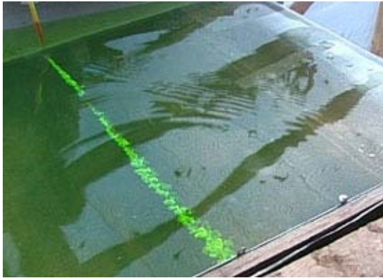
Abbildung 158: Farbfadenversuch vor dem Überlaufkörper mit 10° Anlauf
