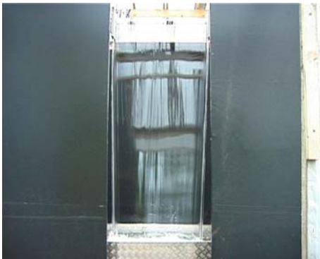
Abbildung 92: Wasserschleier bei 15 l/s
