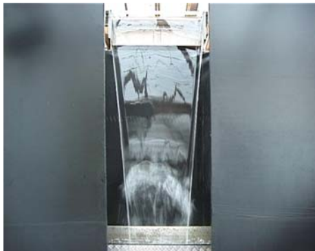
Abbildung 46: Überlaufkörper mit rechtem Winkel, L= 200 mm
