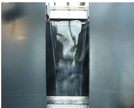
Abbildung 42: Überlaufkörper mit rechtem Winkel, L= 50 mm
