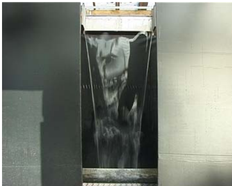
Abbildung 40: Überlaufkörper mit rechtem Winkel, L= 25 mm
