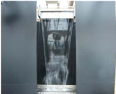
Abbildung 57: Überlaufkörper mit 15° Anlauf, r= 35 mm
