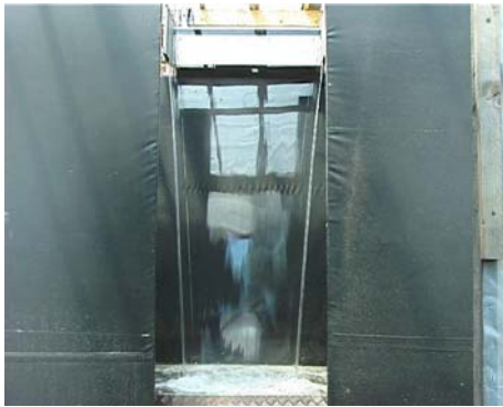
Abbildung 70: Wasserschleier bei 4 l/s
