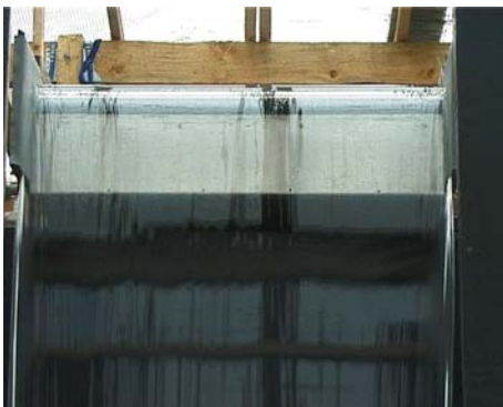
Abbildung 93: Detail - Wasserschleier bei 15 l/s
