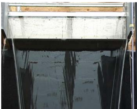
Abbildung 62: Detail - Überlaufkörper mit 30° Winkel, L= 50 mm
