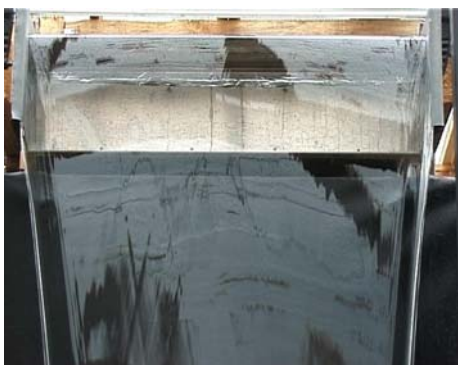
Abbildung 47: Detail - Überlaufkörper mit rechtem Winkel, L= 200 mm
