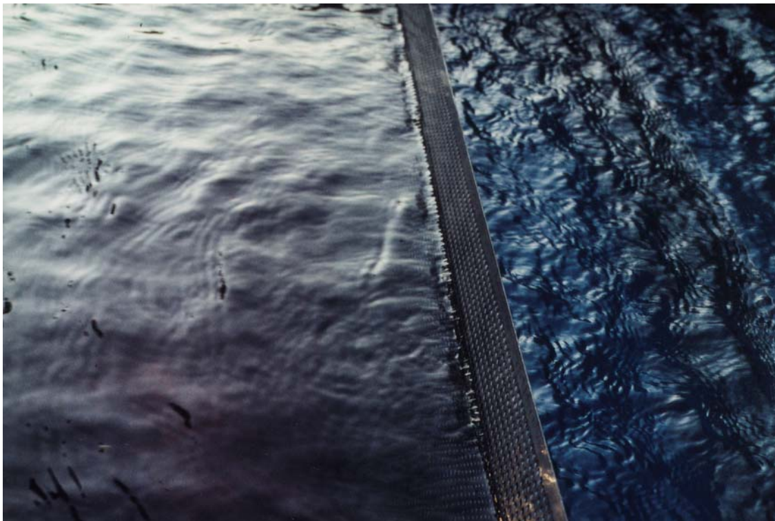
Abbildung 32: Beruhigung mittels Lochblech. Fließrichtung von rechts nach links
