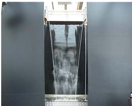
Abbildung 61: Überlaufkörper mit 30° Winkel, L=50 mm
