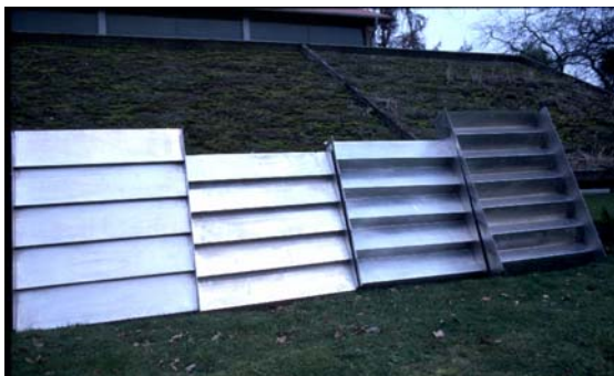
Abbildung 27: Treppenmaterial der Versuchsreihe WT 2 Prop. 1:1, 2:1, 4:1, 8:1 von rechts nach links
