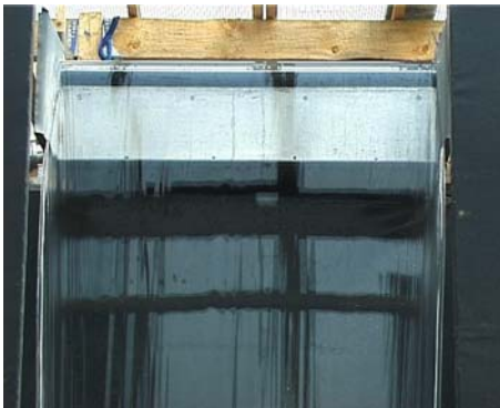
Abbildung 87: Detail - Wasserschleier bei 12 l/s
