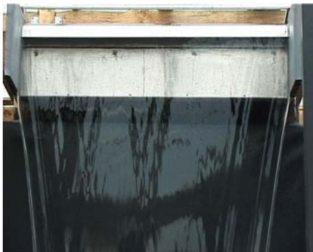
Abbildung 58: Detail - Überlaufkörper mit 15° Anlauf, r= 35 mm
