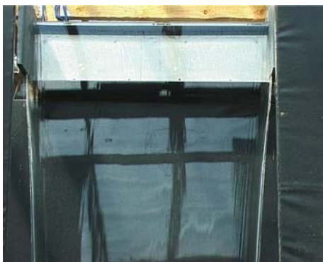
Abbildung 73: Detail - Wasserschleier bei 5 l/s
