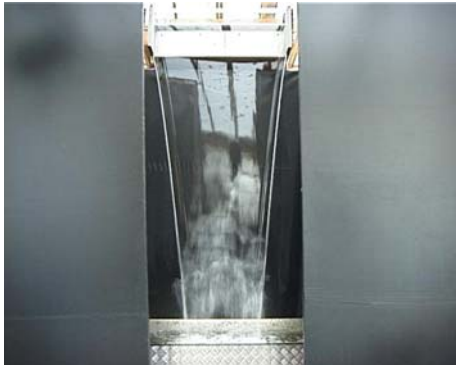
Abbildung 66: Wasserscheier bei 2 l/s
