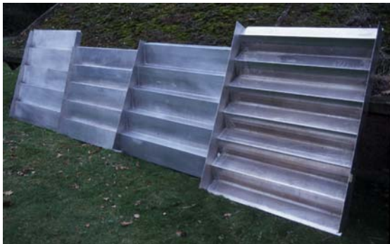
Abbildung 26: Treppenmaterial der Versuchsreihe WT 1 Prop. 1:1, 1:2, 1:4, 1:8 von rechts nach links
