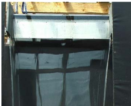
Abbildung 71: Detail - Wasserschleier bei 4 l/s
