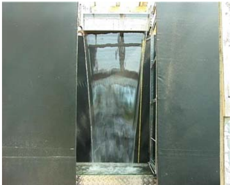
Abbildung 44: Überlaufkörper mit rechtem Winkel, L= 100 mm
