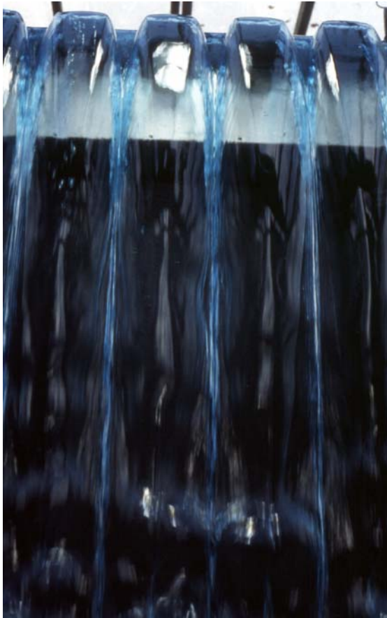
Abbildung 160: Wasserschleier über Rechteckkante
