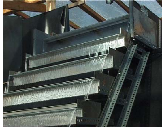
Abbildung 163: Kaskade mit 20 cm Fallhöhe und 1,5 l/s
