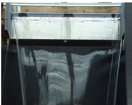
Abbildung 43: Detail - Überlaufkörper mit rechtem Winkel, L= 50 mm
