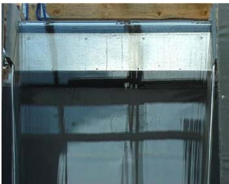
Abbildung 81: Detail - Wasserschleier bei 9 l/s
