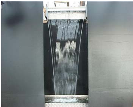
Abbildung 59: Überlaufkörper mit 15°Anlauf, r= 45 mm
