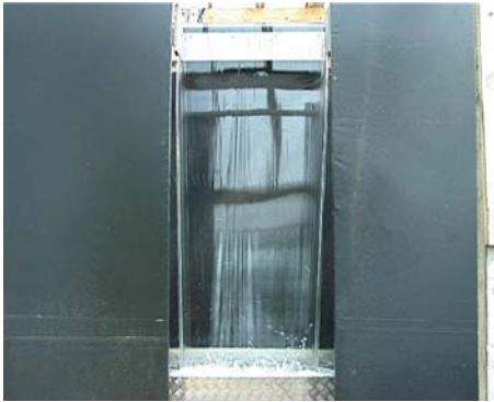
Abbildung 86: Wasserschleier bei 12 l/s
