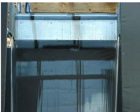
Abbildung 85: Detail - Wasserschleier bei 11 l/s
