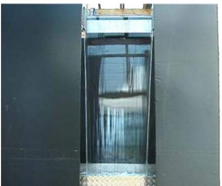
Abbildung 84: Wasserschleier bei 11 l/s
