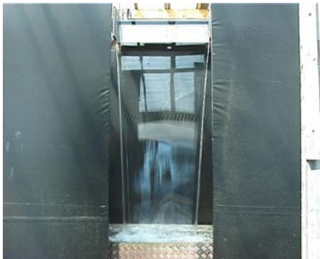
Abbildung 72: Wasserschleier bei 5 l/s
