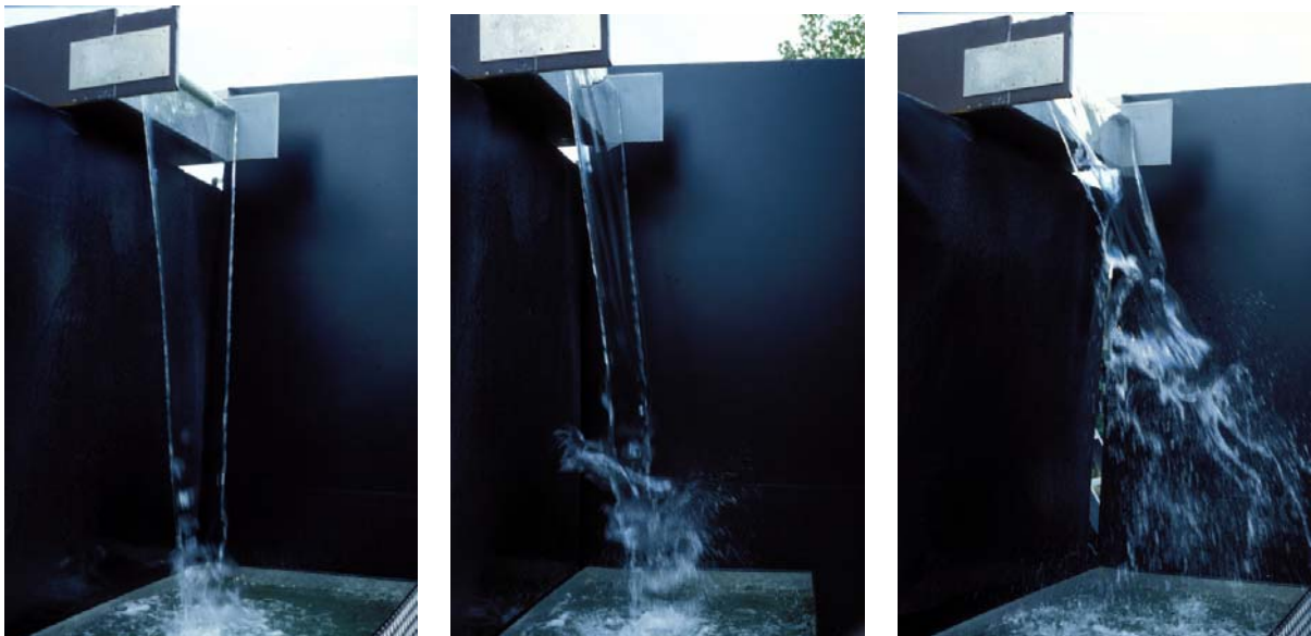
Abbildung 33: Wasserschleier unter Windeinfluss, Bildfolge von links nach rechts: 1,2,3
