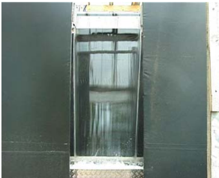
Abbildung 88: Wasserschleier bei 13 l/s
