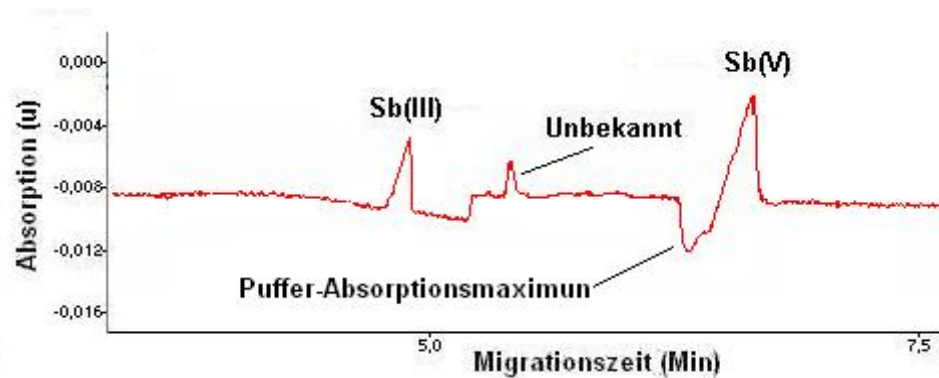
Abbildung 9-15: Elektropherogramme einer Sb-Standardlösung mit ca. 27 mg/L Sb(V) und ca. 33 mg/L Sb(III), Pufferkonzentration: 7,5 mmol/L, pH-Wert: 5,5, Modifizier: 0,2 mmol/L HTAB, Detektion: indirekte UV, mit Peakumkehr
