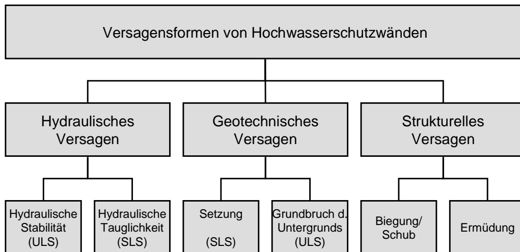
Abbildung 3-18: Hauptversagensmechanismen von Hochwasserschutzwänden [vgl. OUMERACI ET AL., 2001].
