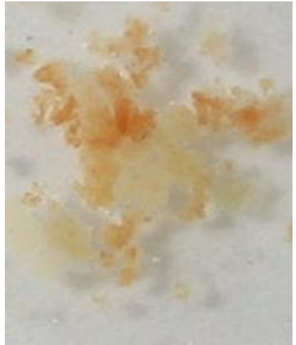
Abbildung 5.10: rötlicher, hochangereicherter ANAMMOX-Biofilm (Delft, NL)
