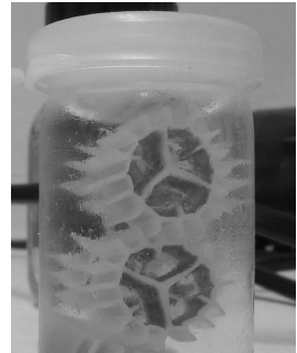
Abbildung 3.8: Erster Anwuchs eines Biofilmes im Aufwuchskörper
