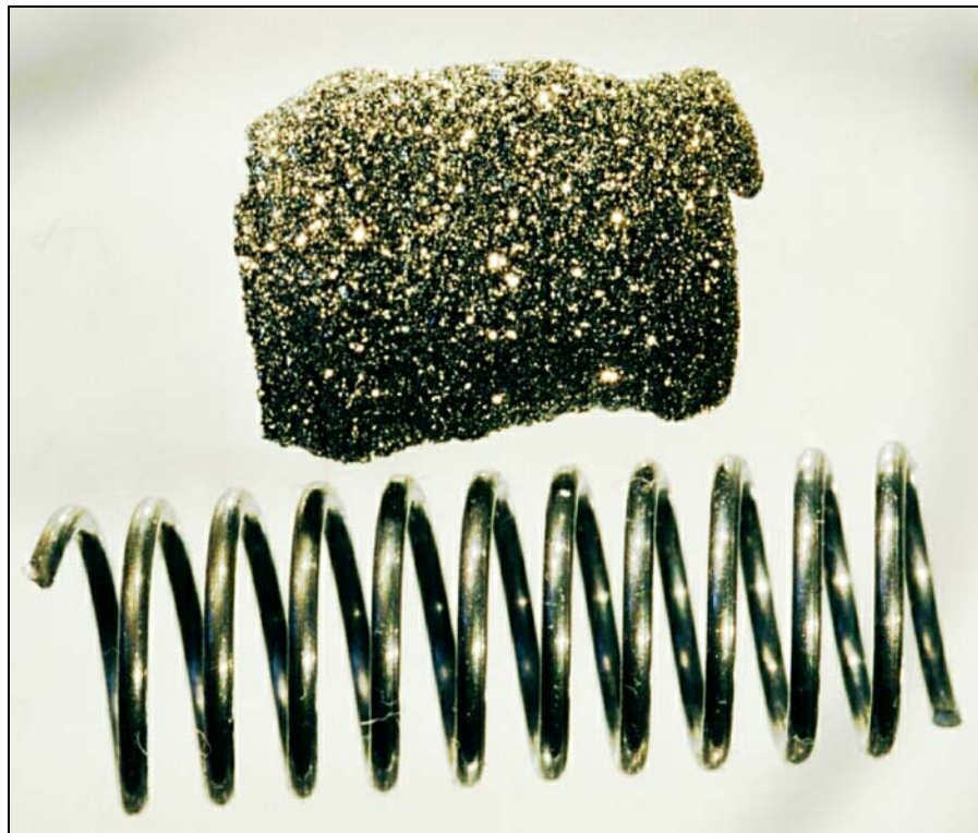
Abbildung 6.8 Eingesetzte Spirale (unten); siliciertes Produkt (Versuch 24 - Fe 3 Si)
