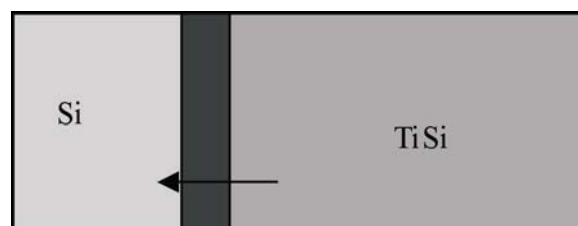
Abbildung 7.9 Schematischer Verlauf des Kristallwachstums von Titansilicid (Pfeilrichtung \equiv Wachstumsrichtung; Grenzschicht als dunkle Phase)
