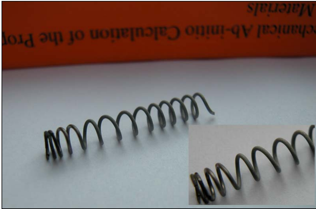
Abbildung 7.3 Silicierte Titanspiralen aus Versuchsreihen 3 (Versuchstemperatur: 1000 °C - Reaktionszeit: 2 h)
