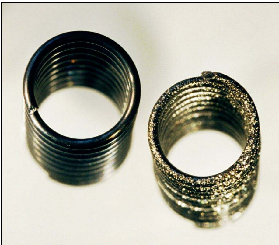
Abbildung 6.3 Eingesetzte Eisenspirale (links); Produkt aus Eisensilicid, FeSi
