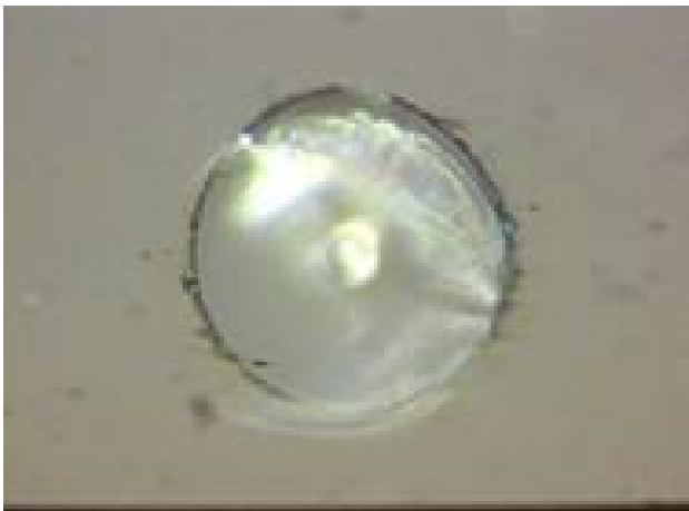
Abbildung 4.12: Lichtmikroskopische Aufnahme einer typischen Defektstelle an der Oberfläche der Kristallfacette. Der Durchmesser der Defektstelle beträgt 60 \mu\text{m} .
