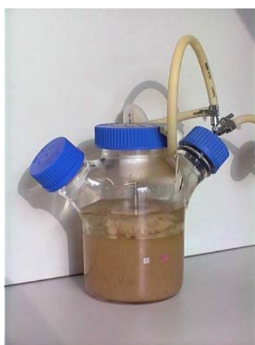
Abb. 5-4 Spinnerflask-Kultivierung von Chaetomium globosum mit interner Sauerstoffmessung
