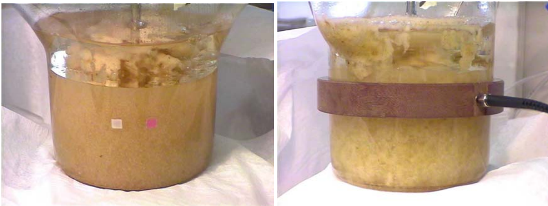
Abb. 5-7 Internes Sauerstoffmesssystem; eingeklebte sauerstoffsensitive Folien (links) und Auslesen der Messsignale über das Glasfaserkabel (rechts, Fibox 2, Presens GmbH)
