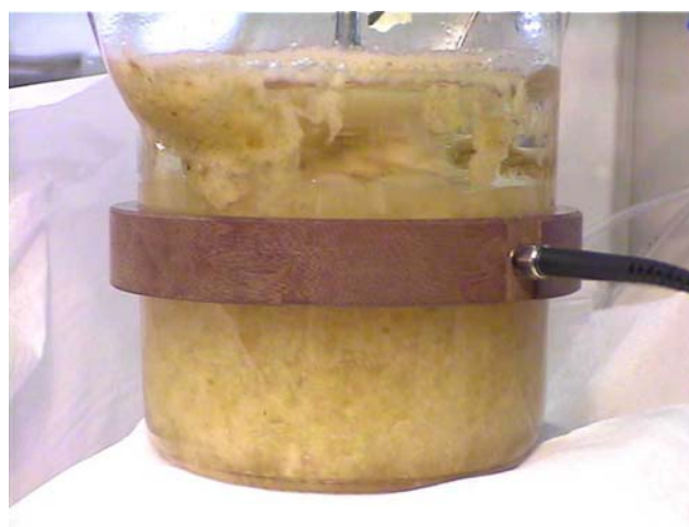
Abb. 5-4 Spinnerflask-Kultivierung von Chaetomium globosum mit interner Sauerstoffmessung
