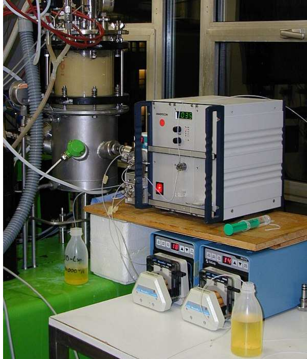
Abbildung 8: Der MBR-Fermenter in Bielefeld mit angeschlossenem FIA-System
