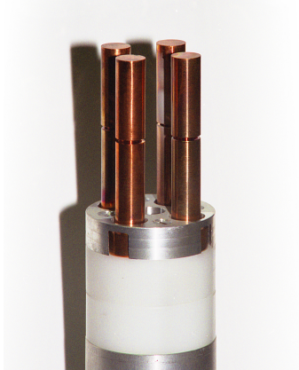
Abbildung 3.25.: Photo der segmentierten Fallenstäbe der linearen Paul-Falle PT2
