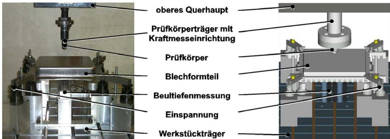
**Bild 7-4:** Beulprüfstand für quasi-statische Belastung, Punktlast
