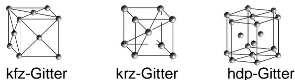
**Bild 2-1:** Grundgitter der häufigsten Metalle
