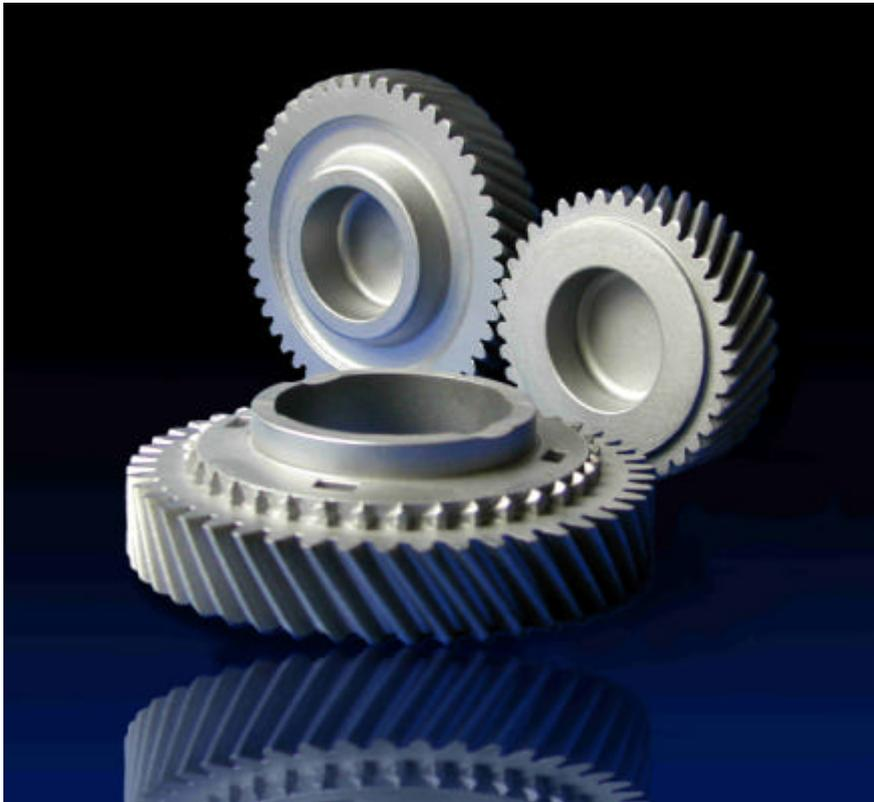
**Bild 8.1:** Im Rahmen dieser Arbeit präzisionsgeschmiedete Zahnräder
