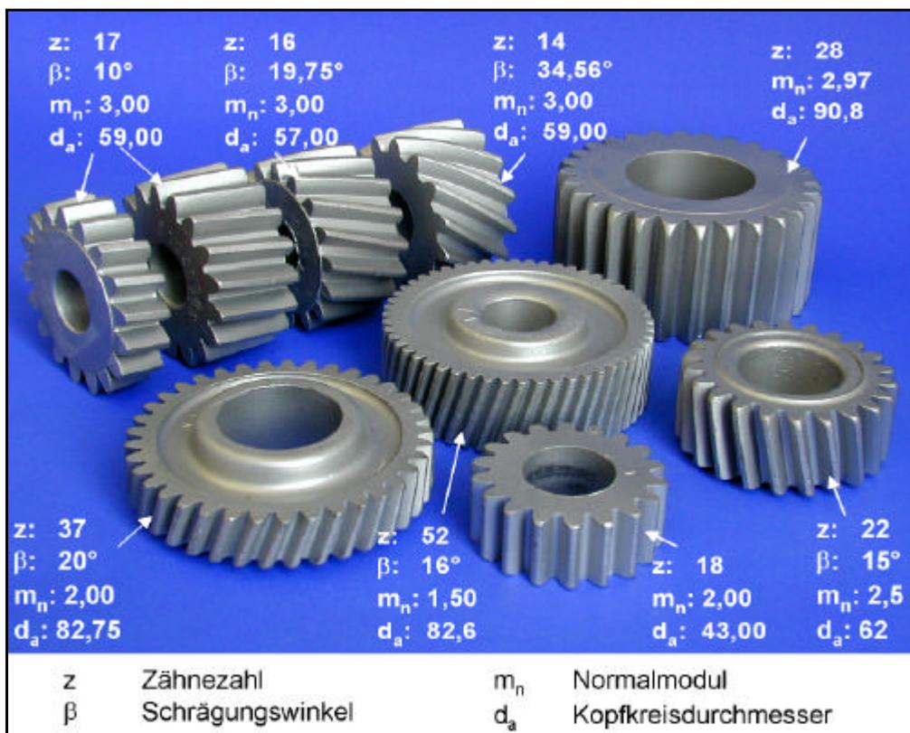
**Bild 2.14:** Gerad- und schrägverzahnte präzisionsgeschmiedete Zahnräder für unterschiedliche Anwendungsfälle (IFUM)
