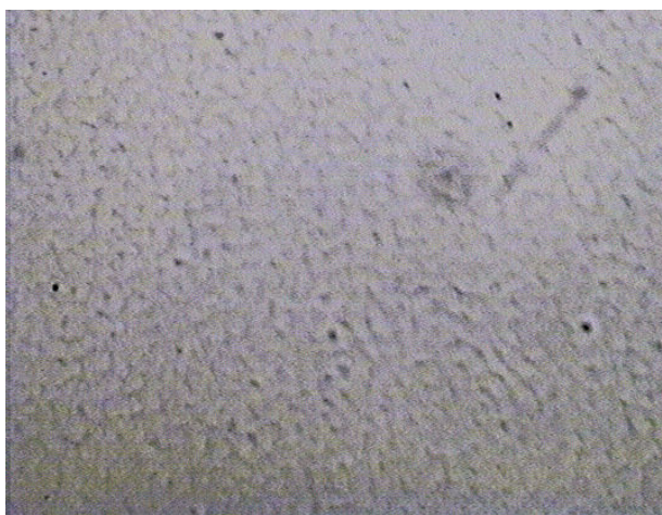
Bild 7.6: Mikroskopaufnahme der SME-Germanium-Oberfläche mit 1250-facher Vergrößerung
