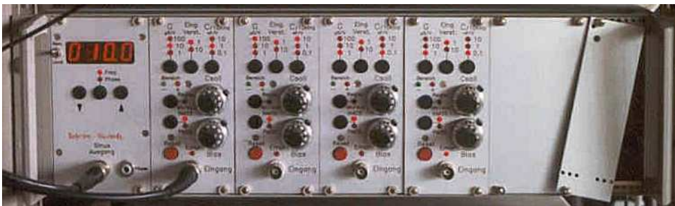
Bild 9.12: Meßgerät für den Betrieb von EIS-Strukturen im Elektrolyten
