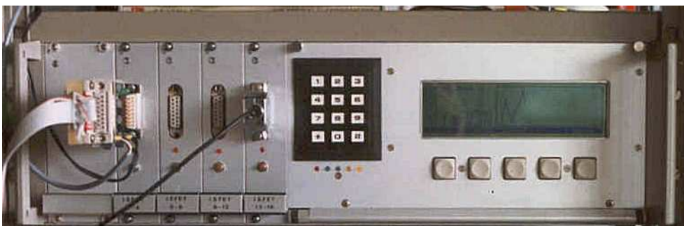
Bild 9.13: Meßgerät für ionensensitive Feldeffekttransistoren
