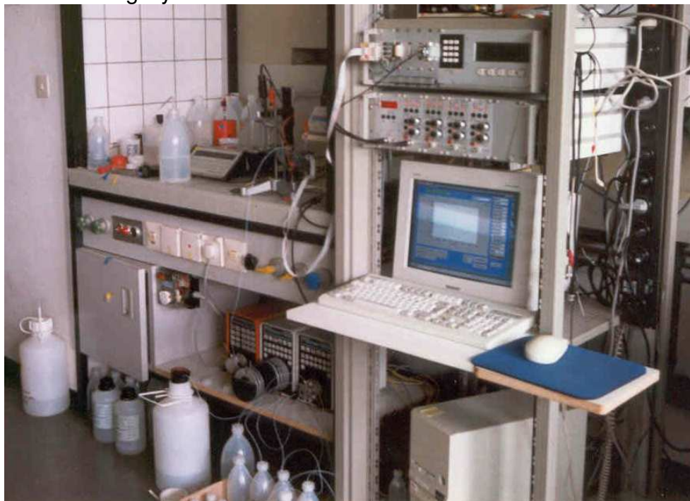
Bild 9.20: Meßplatz zur Messung der Sensorsignale von ionensensitiven Strukturen.
