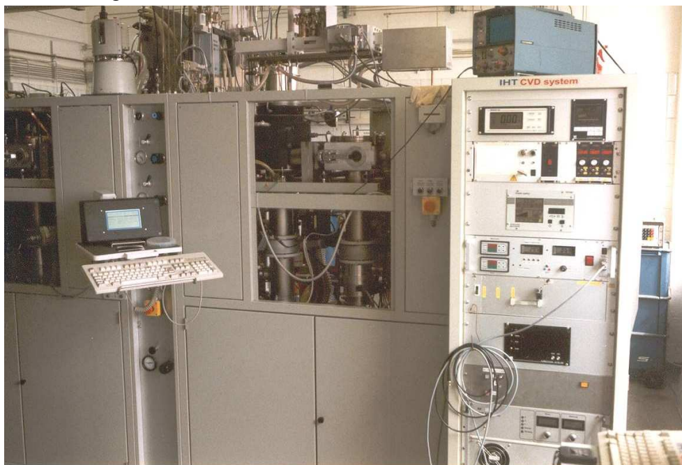
Bild 9.2: Foto der Prozeßanlage für die Abscheidung von diamantartigen Schichten und Tantalpentoxid aus einem metallorganischen Precursor.
