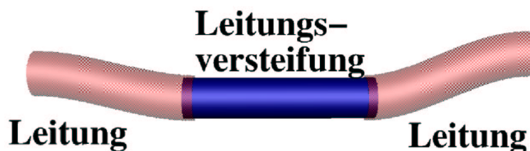
Abbildung 4.12: Beispiel einer Leitungsversteifung
