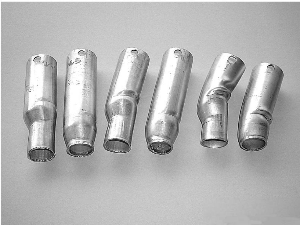
**Bild 6.17:** Deformierte Verjüngungsabsorber  $\varnothing 50 \times 2 \times 125$ -AlMgSi<sub>0,5</sub> nach einem Schrägaufprall mit  $\alpha = 5^\circ$  (links),  $\alpha = 10^\circ$  (mitte) und  $\varnothing 50 \times 2 \times 100$ -AlMgSi<sub>0,5</sub> nach einem Schrägaufprall mit  $\alpha = 20^\circ$  (rechts) mit gelenkiger Anbindung ( $\varphi_D = 0,25$ ;  $\alpha_D = 15^\circ$ )
