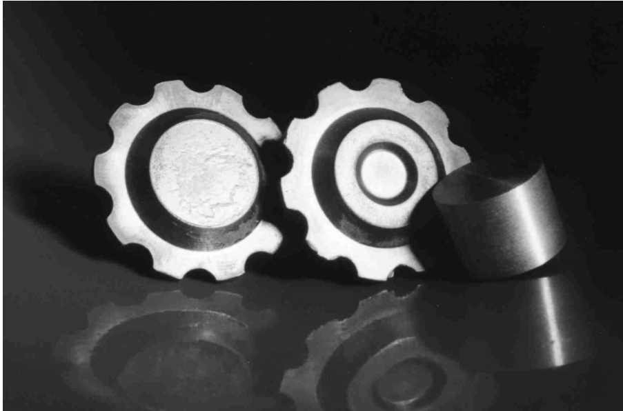
Bild 5.25: Geschmiedete Laufrollen aus AZ31 mit einem Rohteil
