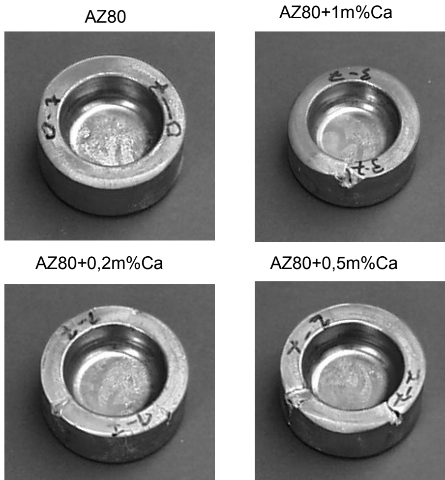
Bild 6.2: Formfüllung und Rissbildung der Bauteile B1 bei einer Rohteiltemperatur von 300 °C und einer Werkzeugtemperatur von 200 °C
