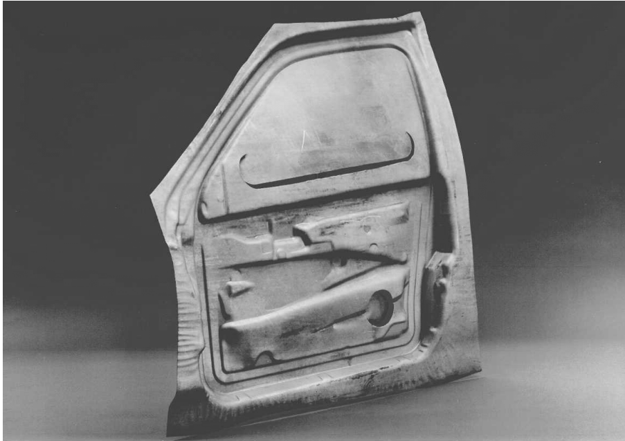
Bild 2.12: Prototyp einer Innentür aus einer Magnesiumknetlegierung (VW AG)
