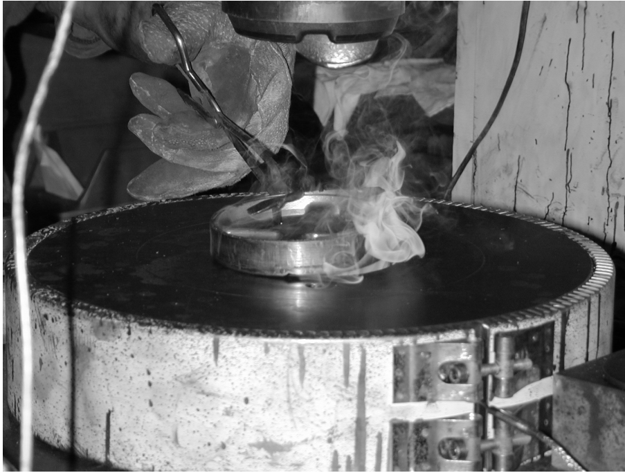
Bild 7.6: Zweite Stufe: Entnahme des geschmiedeten Bauteils aus dem Gesenk
