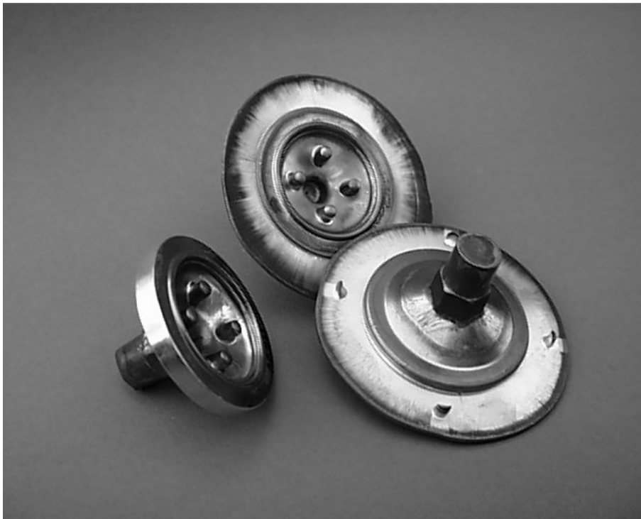
Bild 7.1: Gesenkgeschmiedete Fußbodenstütze (Durchmesser des Fertigteils links 57 mm) aus ZK60 und AZ80, Werkzeug der Firma INOFER, Belgien
