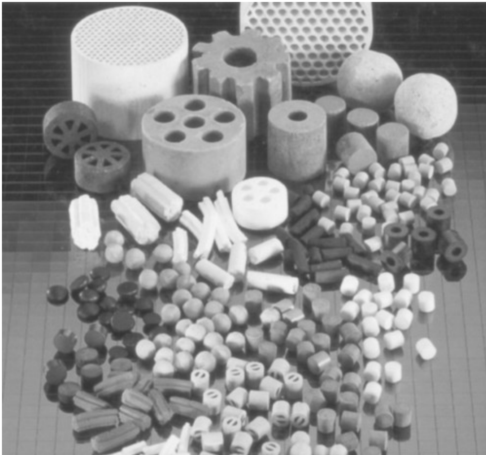
Abb. 2.1: Typische poröse Materialien, die als Katalysatorträger, Adsorbentien oder wie in dieser Arbeit, als SLP-Sorbens z. B. in Schüttungen oder als Wabenkörper Verwendung finden.
