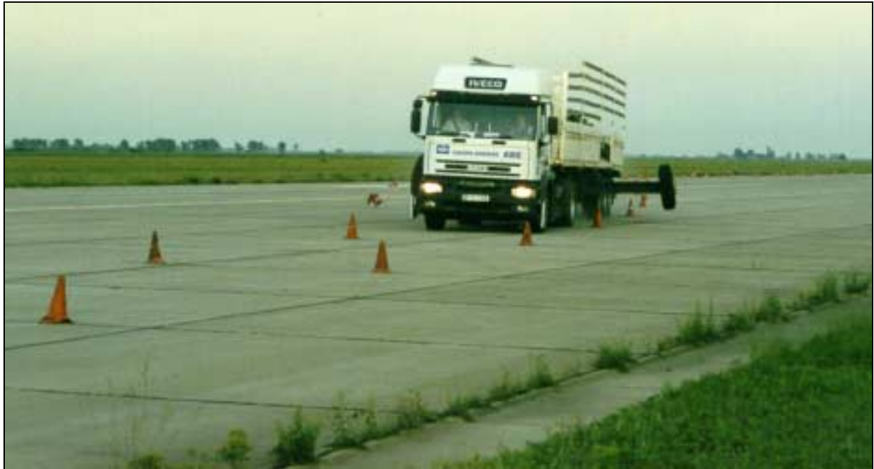
Abbildung 7: Einfacher Fahrspurwechsel, pfadfolgende Methode
