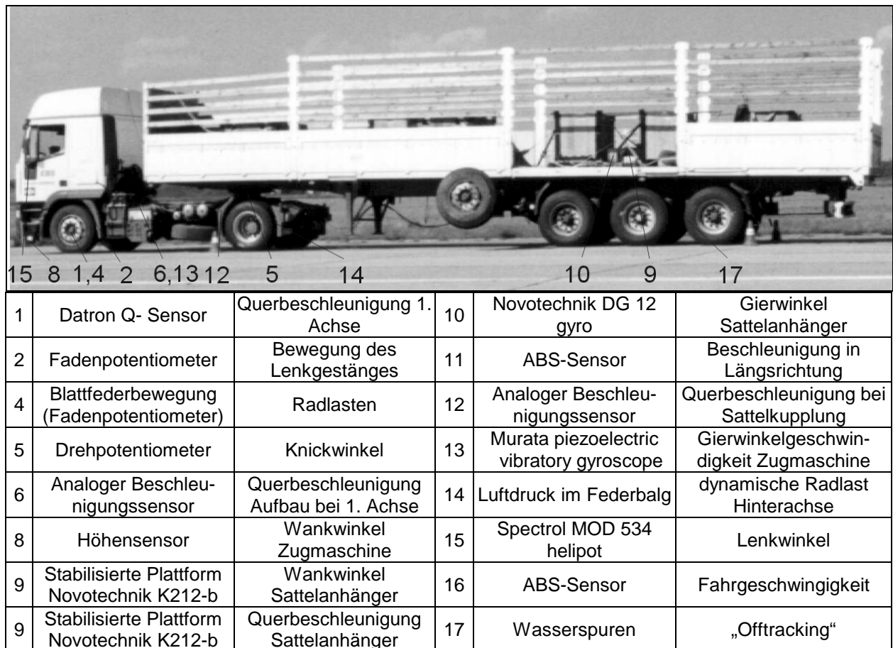
Abbildung 24: Versuchsfahrzeug mit Meßaufnehmern
