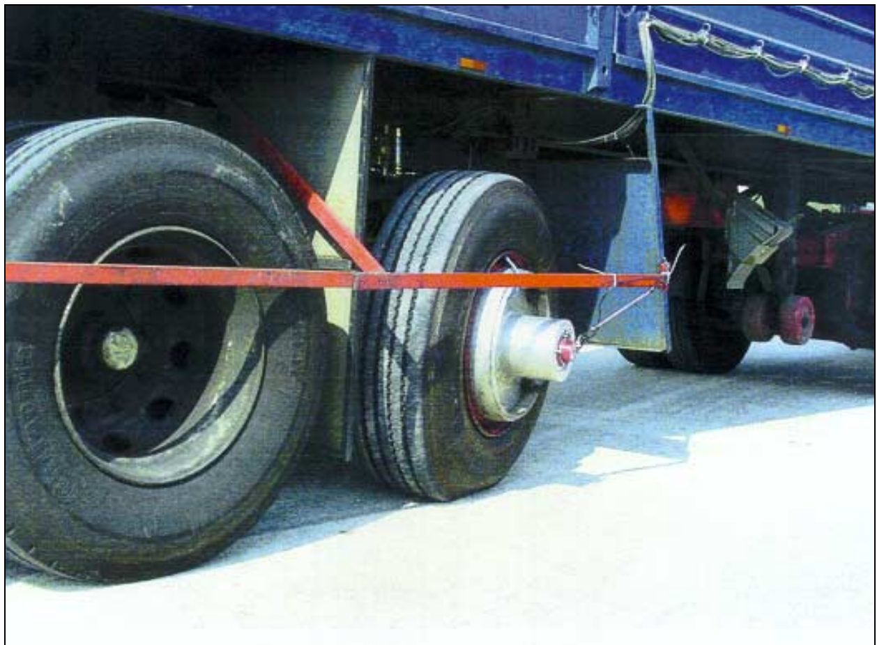
Abbildung 18: Meßachse im Betrieb, Schräglaufmessung
