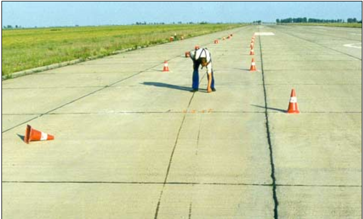
Abbildung 25: Ermittlung des Offtracking
