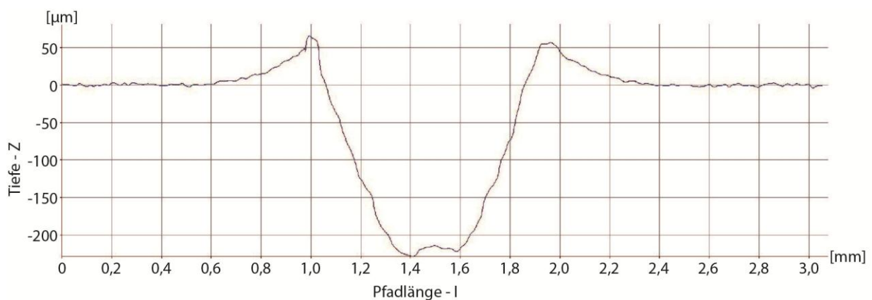
Abb. 97 Linientopographie durch den Mittelpunkt des eingebrachten Defekts
