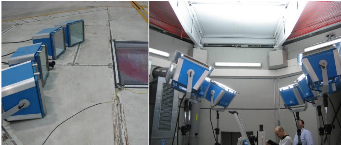
Abb. 35 Aufbau des seitlichen (links) und des unteren (rechts) Kamera- und Beleuchtungssystems
