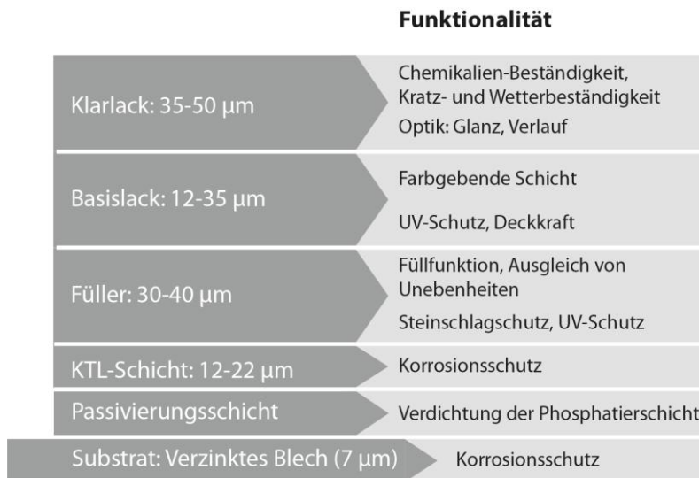
Abb. 17 Aufbau eines Multischichtsystems in der Automobilindustrie
