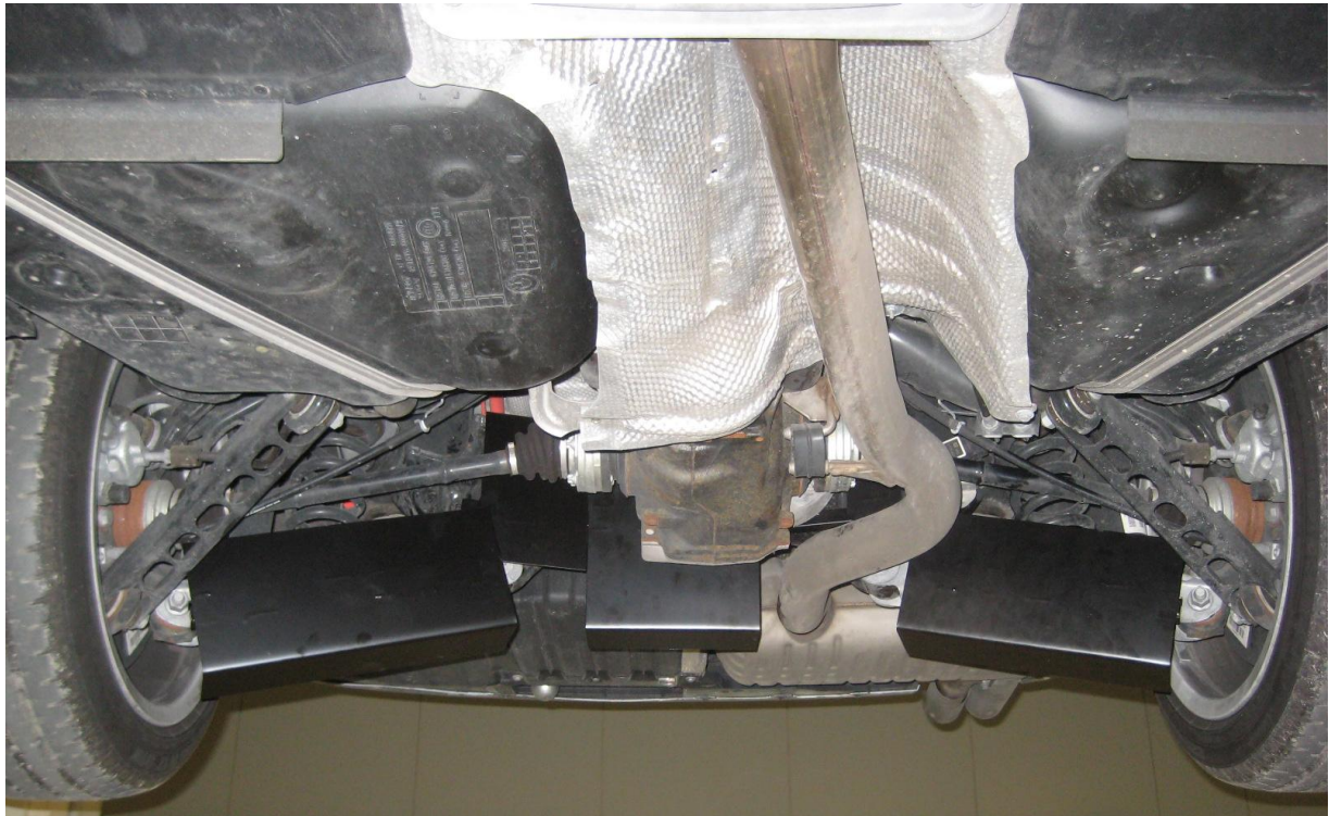
Abb. 37: Probebleche befestigt am Sturzlenker und am Hinterachsträger
