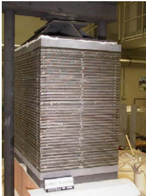
Abbildung 4-8: SOFC-Stack in planarem Aufbau [FZ Jülich]
