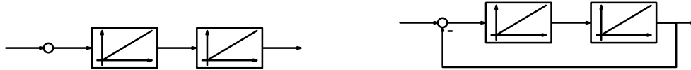
Abbildung 5.2: Blockschaltbilder der zeitoptimal zu steuernden Systeme: Zweifach integrierendes System sowie ungedämpftes PT_2 -System
