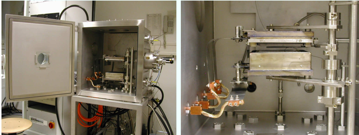
Abbildung 4.2: Äußerer und innerer Aufbau einer CSS Anlage am IFK Jena
