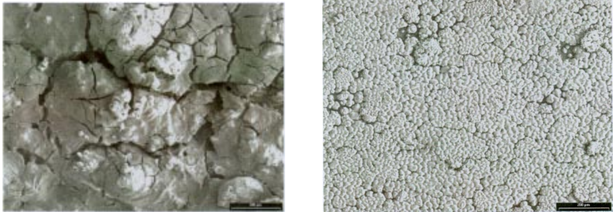
Bild 5-13: Struktur der abgelagerten Verbrennungsrückstände im Bereich der Kolben-Luftmulde; links: unbeschichteter Basiskolben, rechts: TiN-beschichteter Kolben; Vergrößerung 100:1
