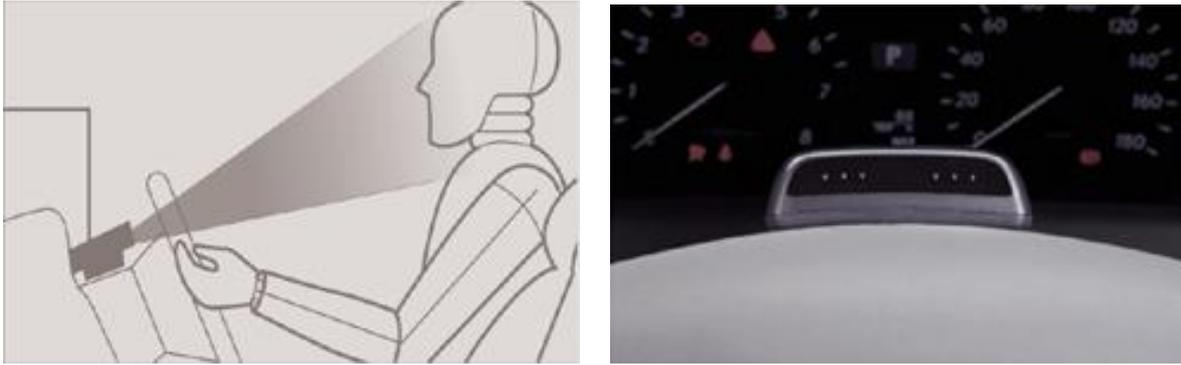
**Abbildung 3.8: Anordnung der Fahrerbeobachtungskamera beim Lexus Pre-Crash Safety System
