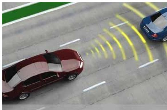
**Abbildung 3.1: Das ACC-System, der Abstandsregeltempomat (KfzTech, 2008)**
