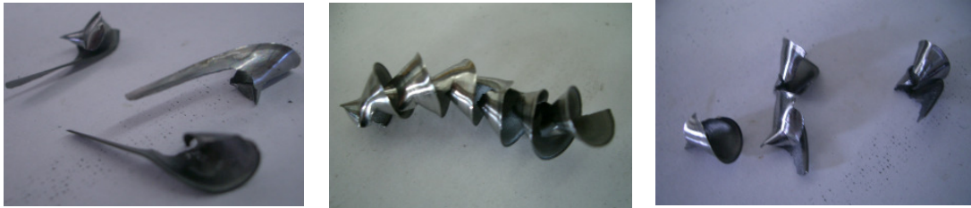
Abb. 79: Typische Abbildung eines Fähnchenspanes, Spiralspanes (Anbohrspan), Bröckelspanes
