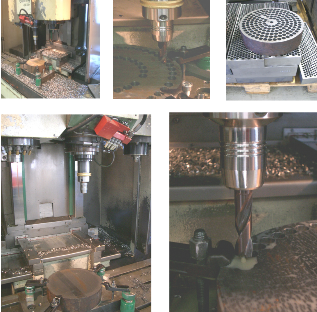
Abb. 66: Versuchsaufbau auf einem vertikalen Bearbeitungszentrum
